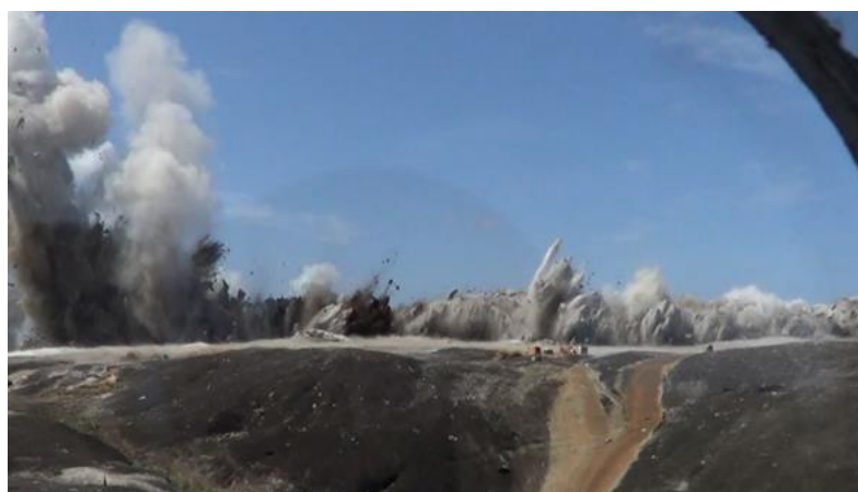
Figura 5: Captura de tela da filmagem do primeiro desmonte. A iniciação do desmonte foi realizada à esquerda do vídeo, onde pode ser verificada uma ejeção do material de tampão. Ainda assim, é possível observar uma retenção gasosa satisfatória nos demais setores do desmonte.
