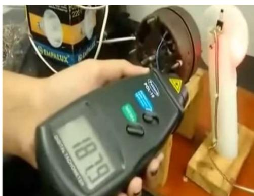
Figura 10: Leitura do tacômetro ótico.
