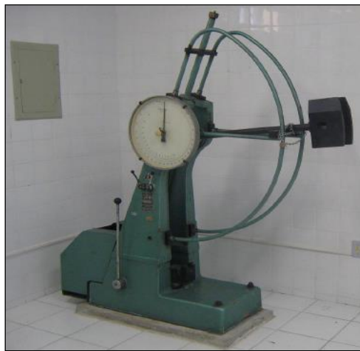
Figura 1—Máquina de impacto Charpy instalada no IFCE no laboratório de ensaios mecânicos (LEM).
