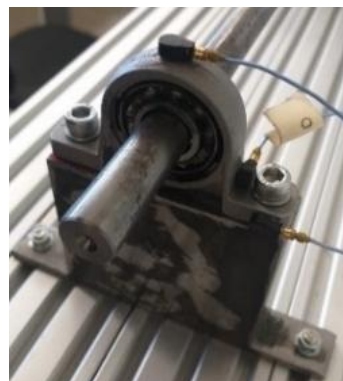
Figure 05: Posicionamento dos acelerômetros no mancal de rolamento.
