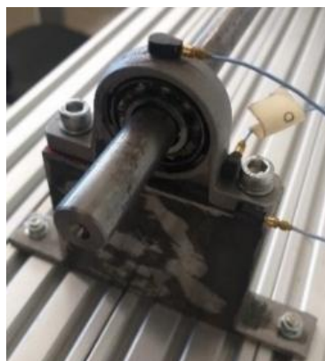
Figura 05: Posicionamento dos acelerômetros no mancal de rolamento.
