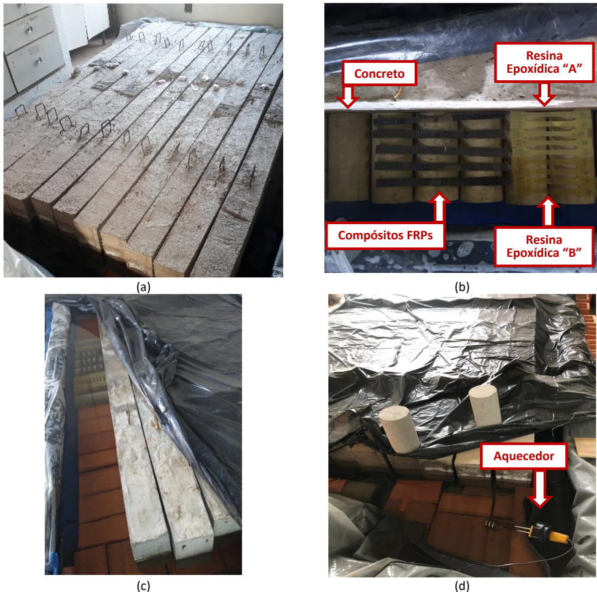
Figura 10: Tanque com: (a) vigas de concreto com e sem sistema de reforço de FRPs, (b) corpos de prova, (c) vigas e corpos de prova durante o ensaio e (d) aquecedor em funcionamento (Sarti Júnior, 2020)
