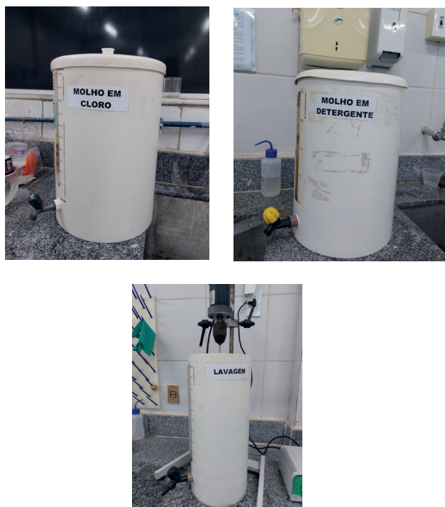
Figura 4 – Etapas de lavagem com os recipientes com cloro, detergente e lavagem mecânica
