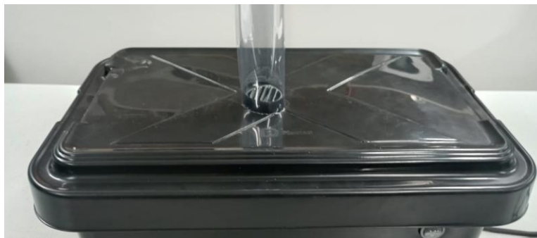
Figura 31 - Tubo de visor perfeitamente encaixado entre a tampa da caixa e o tubo do secador
