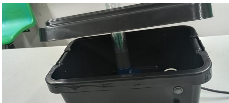
Figura 30 - Tubo de folha de visor transfixando a tampa e encaixado no tubo do secador
