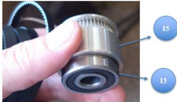
FIGURA 3: POLIA PRODUZIDA COM O ROLAMENTO DE BICICLETA ANEXADO NO SEU INTERIOR. IMAGEM GERADA PELO AUTOR (2021).
