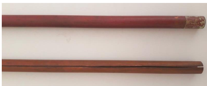
Figura 2 – Tubos de cobre (na parte superior tubo sem corte e na parte inferior tubo com corte)
