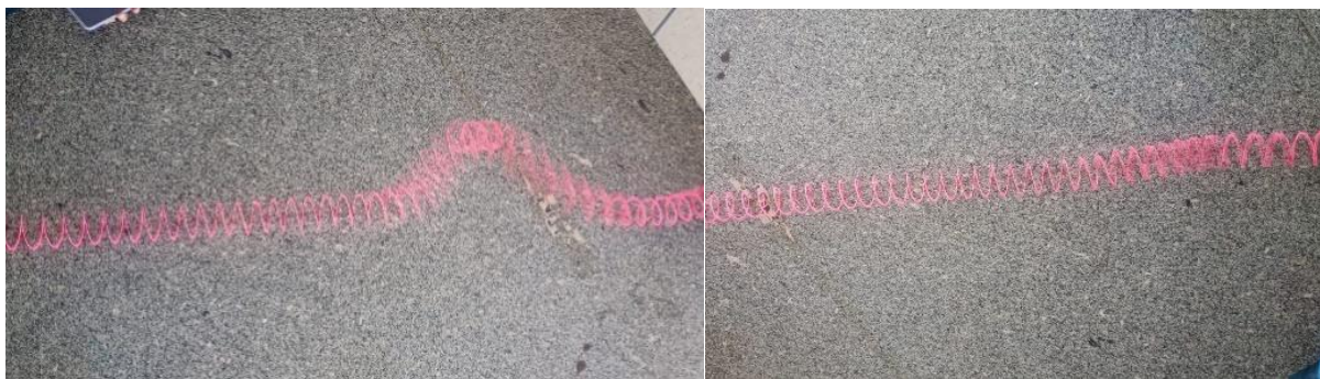
Figura 2 – Onda transversal e longitudinal se propagando na mola maluca
