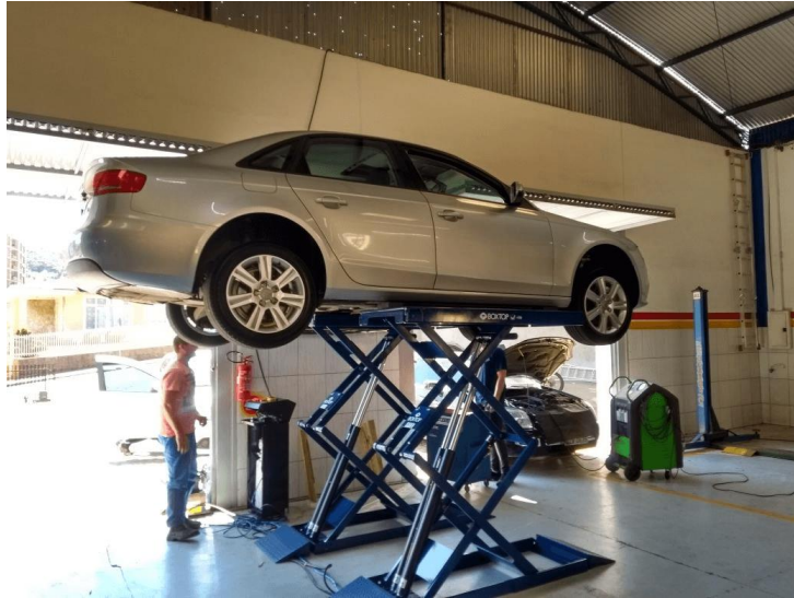
Figura: 25 – Carro em uma oficina sobre um elevador hidráulico
