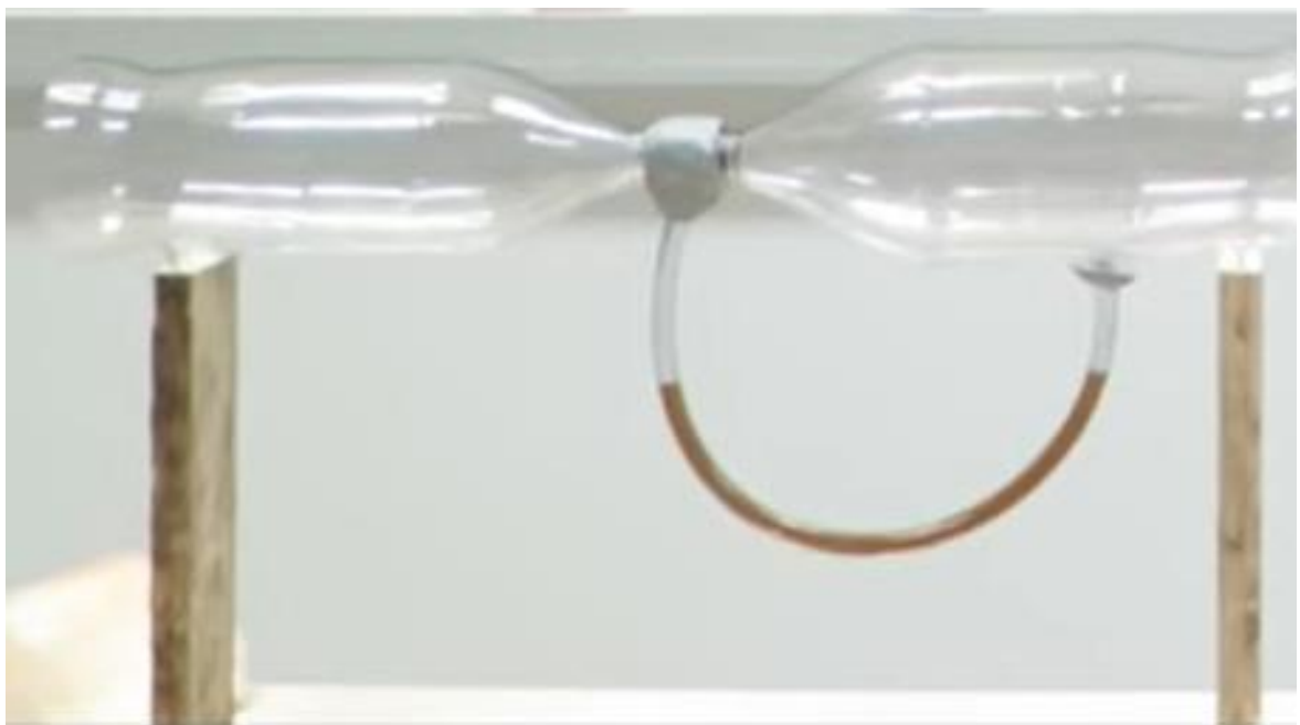
Figura: 77 - Medidor de Venturi de fácil obtenção
