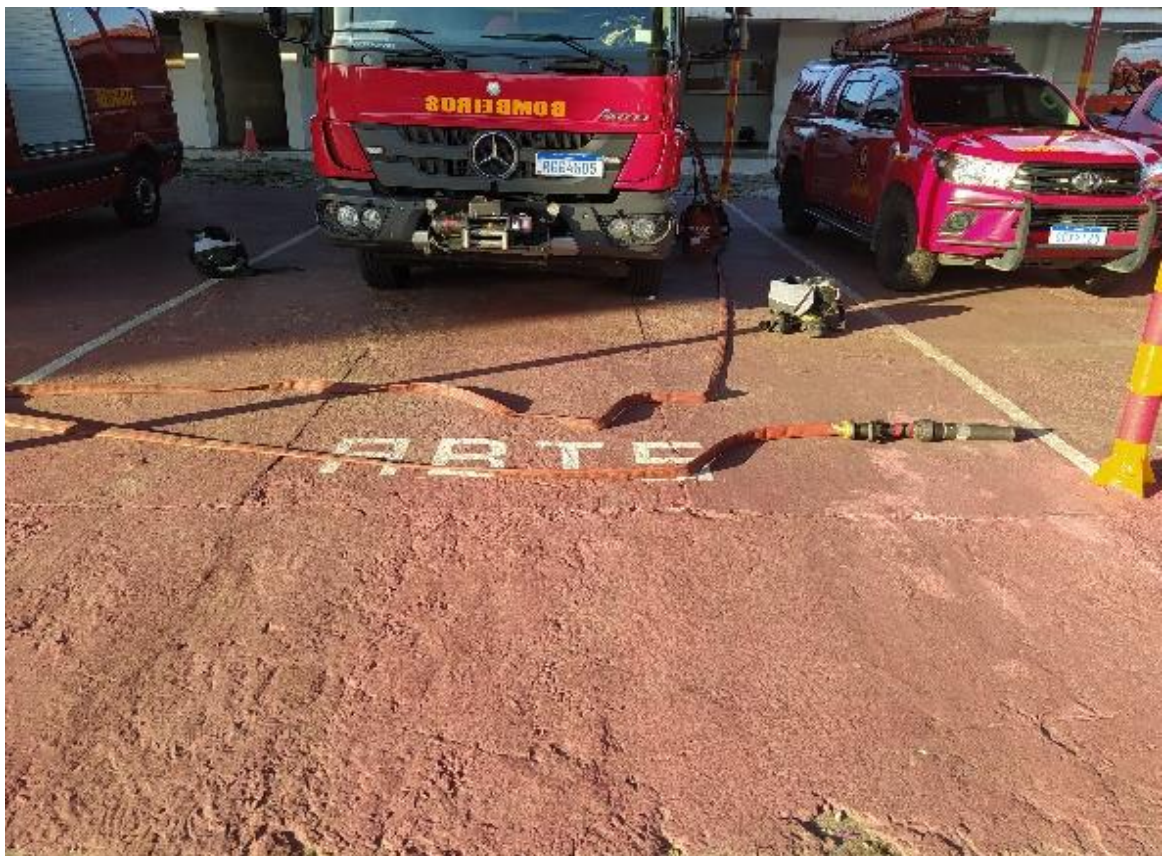
Figura: 103 - Sistema gerador de espuma montado na viatura de Incêndio.
