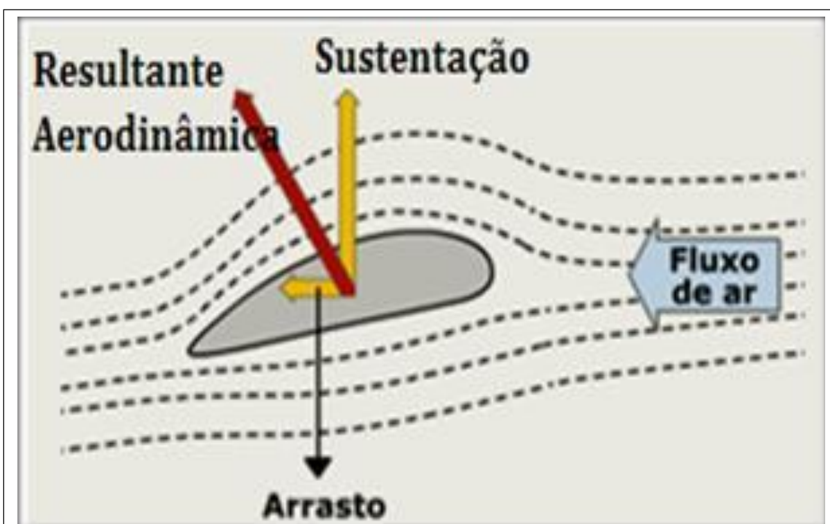
Figura: 54 - fluxo laminar do vento sobre uma asa de avião.
