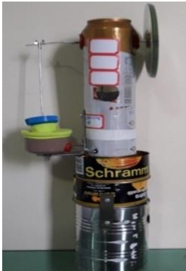
Figura 20 – Motor Stirling construído pelos alunos.
