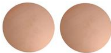
Figura 7 – Discos de cobre de 25 mm de diâmetro.
