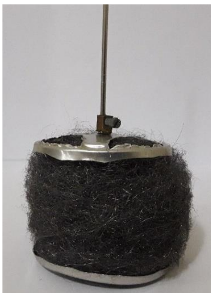
Figura 8 – Pistão deslocador construído.
