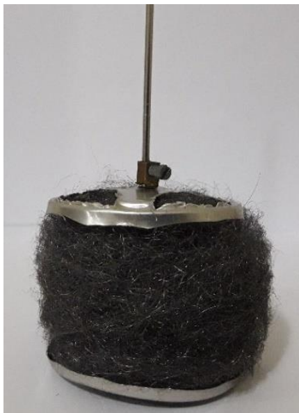
Figura 8 – Pistão deslocador construído.
