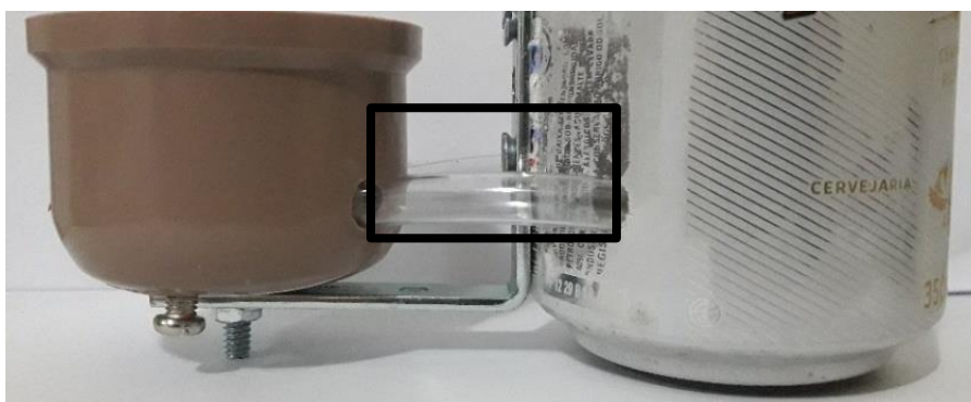
Figura 11 – Condutor de ar interligando a câmara de compressão e o primeiro cabeçote.
