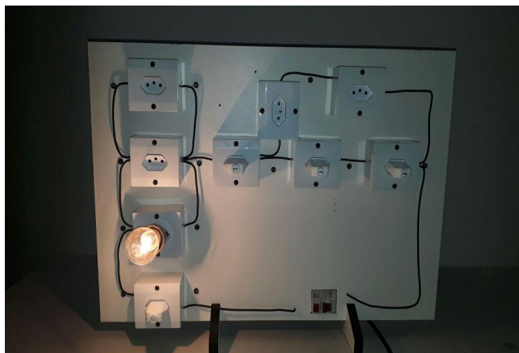
Figura 8: Painel elétrico com montagem para circuito em paralelo com uma lâmpada Fonte: Arquivo pessoal do autor.
