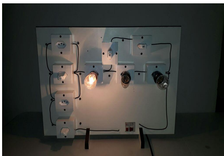
Figura 7: Painel elétrico em curto-circuito. Fonte: Arquivo pessoal do autor.
