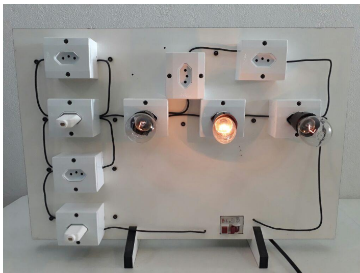
Figura 6: Painel elétrico com a montagem do circuito em série. Fonte: Arquivo pessoal do autor.
