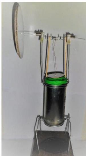
**Figura 4 – Motor *Stirling* pronto (para ser usado nas reflexões desta aula)**
