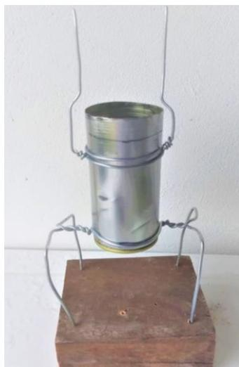
Figura 20 - cilindro apoiado sobre os pés com os suportes do virabrequim
