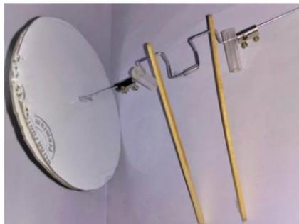
Figura 17 - virabrequim montado com volante acoplado
