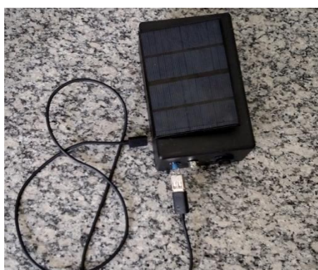
Figura 25 - Carregador solar comercial finalizado
