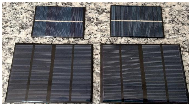
Figura 30 - Placas fotovoltaicas utilizadas nas atividades experimentais
