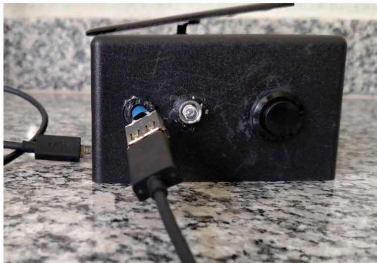
Figura 26 - Carregador solar comercial: Saída USB e sinalização de funcionamento
