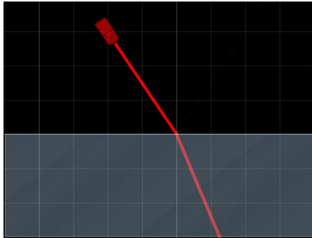
Figura 1 - Refração de um raio de luz que se propaga no vácuo e penetra numa placa de vidro.
