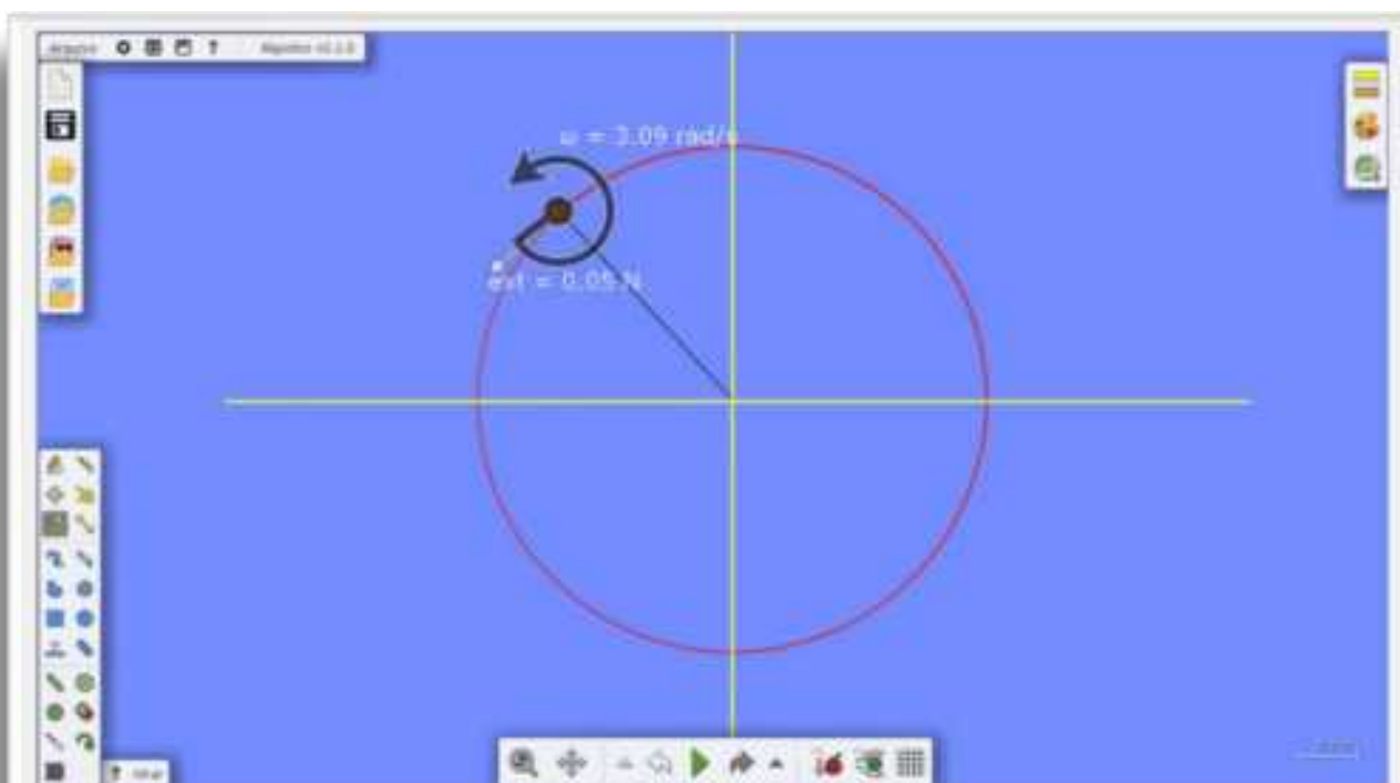
Figura 6.03: Captura de tela do software Algodoo : corpo de massa m preso à extremidade de uma barra fina de massa desprezível, submetido a uma força tangencial de 0,05 \text{ N} e com velocidade angular de 3,09 \text{ rad/s} . Fonte: os autores.
