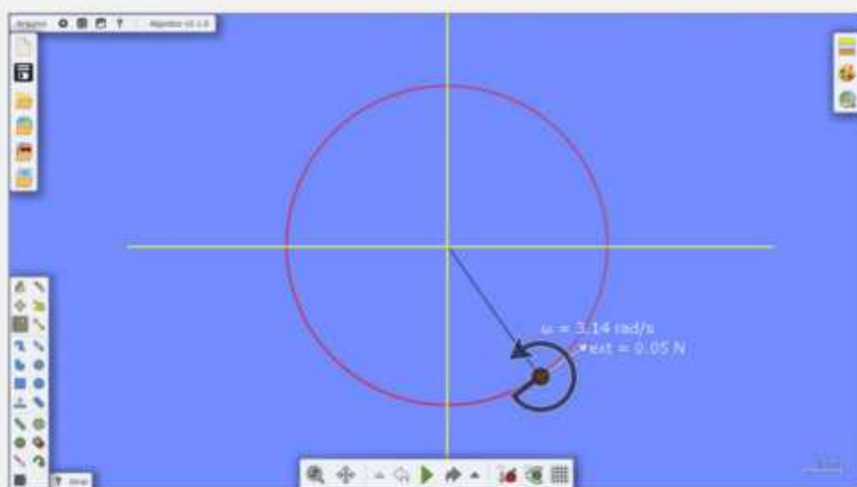
Figura 6.04: Captura de tela do software Algodoo : mesmo corpo de massa m da Figura 6.03 em uma posição angular diferente, preso à extremidade de uma barra fina de massa desprezível, submetido a uma força tangencial de 0,05 \text{ N} e com velocidade angular de 3,14 \text{ rad/s} . Fonte: os autores.
