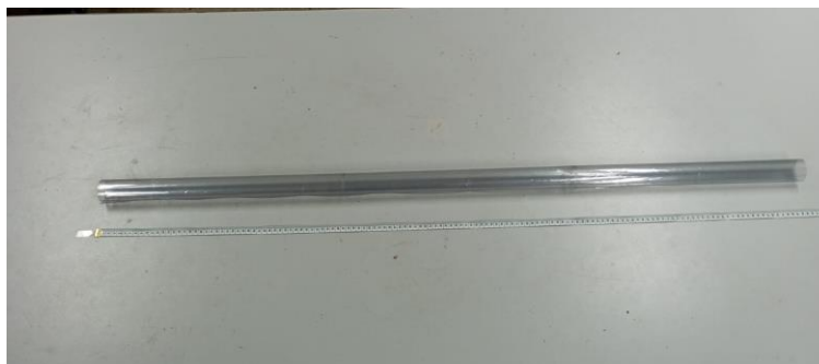
Figura 28 - Tubo feito com folha de visor sendo medido por uma fita métrica
