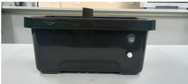
Figura 21 - Visualização da ponta da saída de ar do secador passando do limite da tampa da caixa
