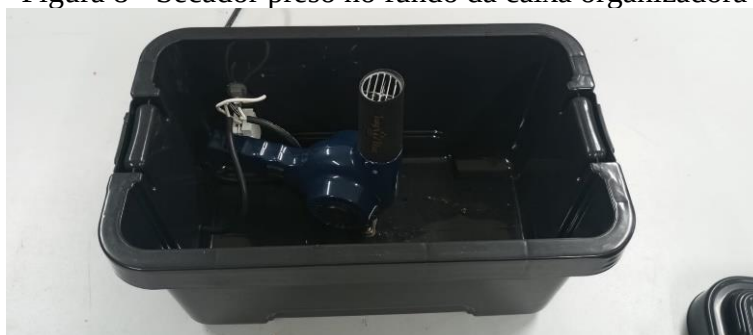
Figura 8 - Secador preso no fundo da caixa organizadora
