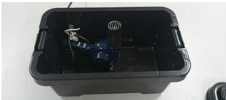
Figura 18 - secador preso no fundo da caixa organizadora utilizando o adaptador em formado de “L”, parafuso e porca
