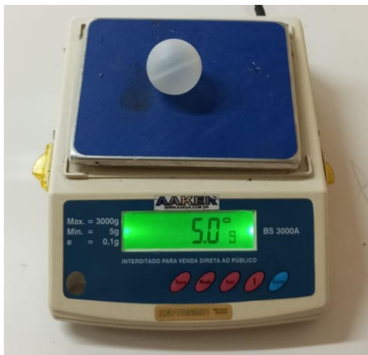
Figura 34 - Balança registrando a massa da bolinha dois após atingir a marca de 5,0g
