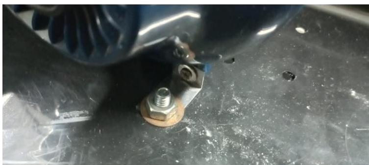
Figura 19 - Visualização do adaptador em “L” prendendo o secador no fundo da caixa organizadora utilizando parafuso, porca e arruela
