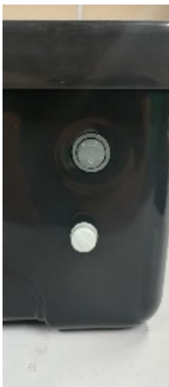
Figura 23 - Botão liga/desliga (acima) e Dimmer (abaixo) na lateral direita da caixa organizadora, bem fixados e dispostos de maneira acessível.
