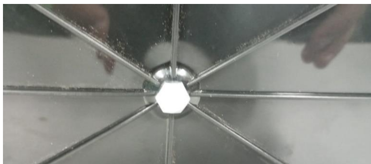
Figura 20 - Visualização da parte de fora da caixa organizadora com parafuso que prende o adaptador
