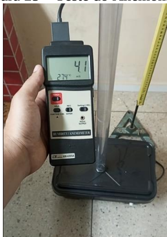
Figura 25 – Teste do Anemômetro
