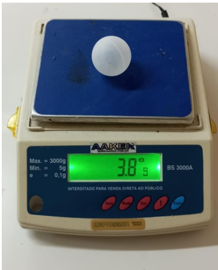
Figura 33 - Balança registrando a massa da bolinha apenas com ar dentro (3,8g)
