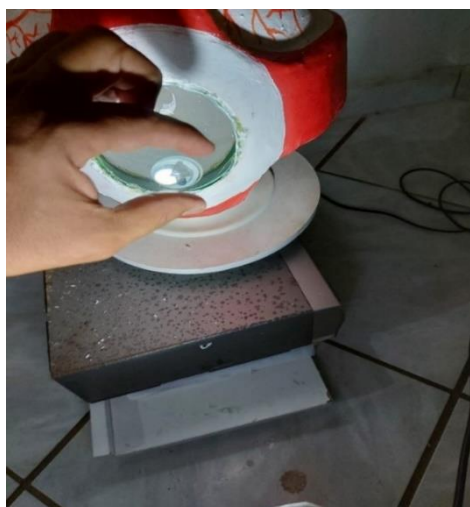
Figura 33 - Imagem virtual, direita e ampliada, situada com o objeto entre o foco objeto ( f_o ) e centro óptico (O) da lente.
