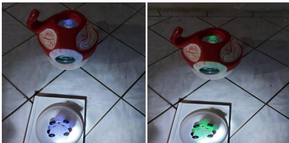
Figura 32 - Imagem real projetada no interior do MEGO (retina), após sofrer refração na "córnea e cristalino" (lentes de acrílico e vidro).
