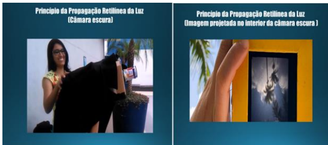
Figura 59 - Luz, câmera e ação (demonstração e projeção da imagem no interior da câmara escura).
