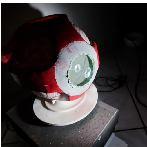
Figura 86 - Projeção da imagem real “dentro da lente” e formação da imagem virtual “fora da lente”.
