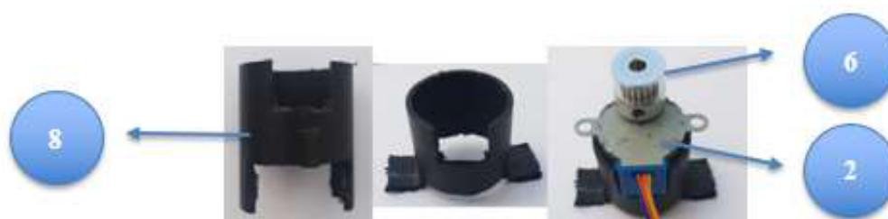
FIGURA 4: SUPORTE DO MOTOR DE PASSO SUPERIOR. IMAGEM GERADA PELO AUTOR (2021).
