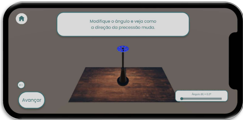
Figura 4 - Segunda cena: Relação entre o ângulo de inclinação do volante e a velocidade de precessão.
