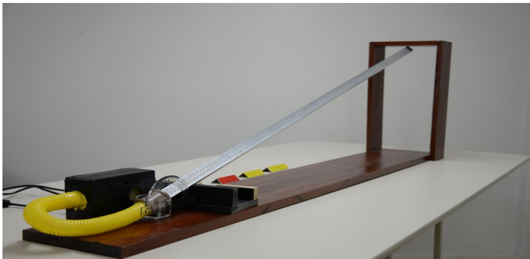
Figura 8 - Trilho de Ar armado para experiência do Plano Inclinado
