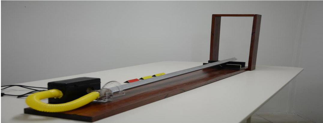
Figura 11 - Trilho de Ar como Plano Horizontal
