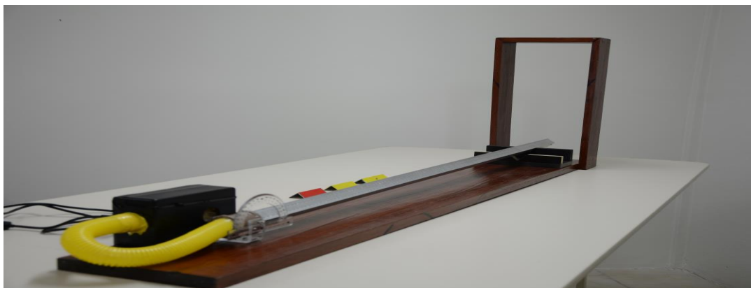
Figura 7 - Trilho de Ar como Plano Horizontal
