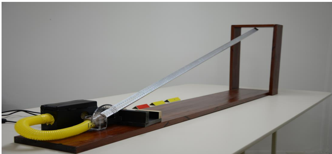
Figura D5: Trilho de ar como plano inclinado
