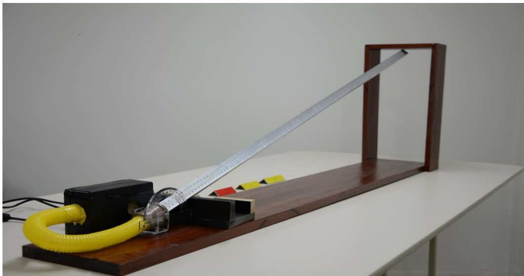
Figura D7: trilho de ar montado para experiência com o plano inclinado
