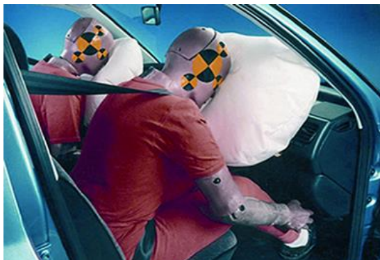
Figura 15 - Airbag aumenta o tempo diminuindo a força
