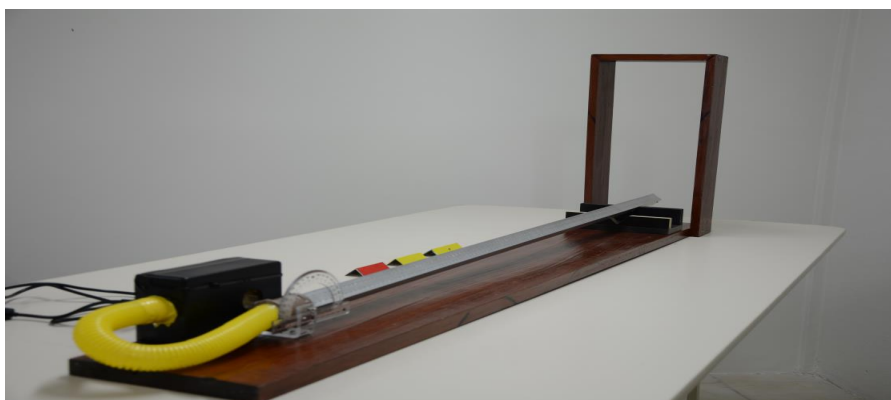
Figura D6: trilho de ar como plano horizontal
