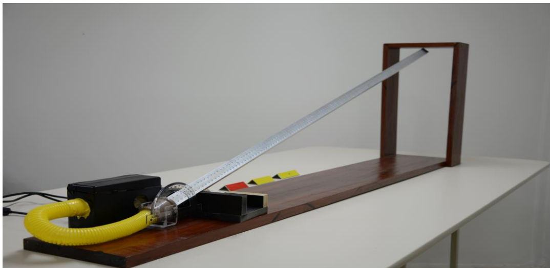
Figura 12 - Trilho de Ar armado para experiência do Plano Inclinado
