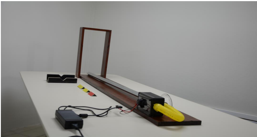
Figura D1: Fonte de tensão (12V-10A e compressor)
