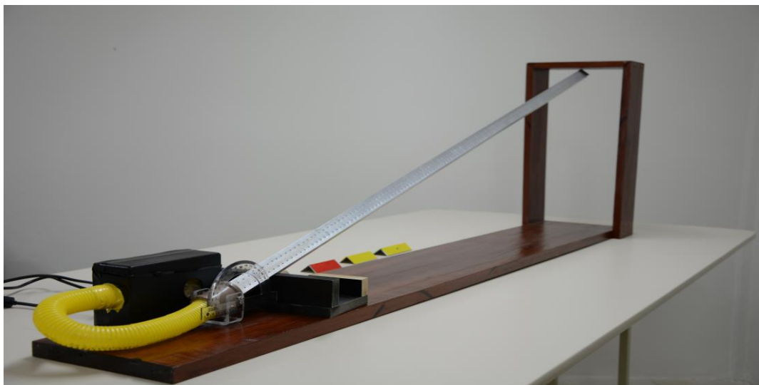
Figura 6 - Trilho de Ar como Plano Inclinado
