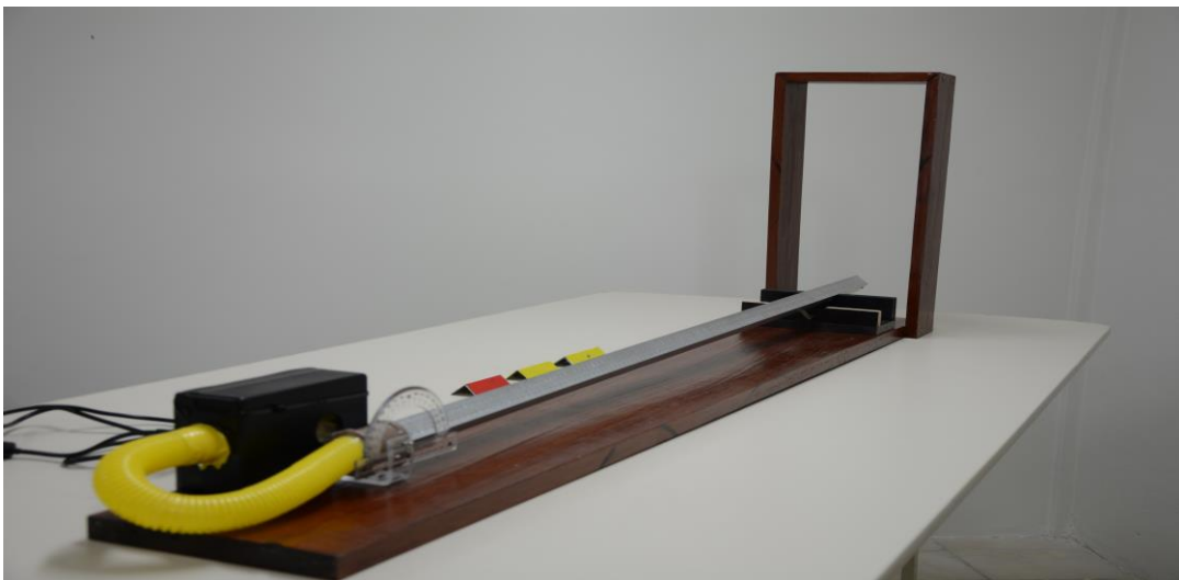
Figura 01 – trilho de ar no plano horizontal
