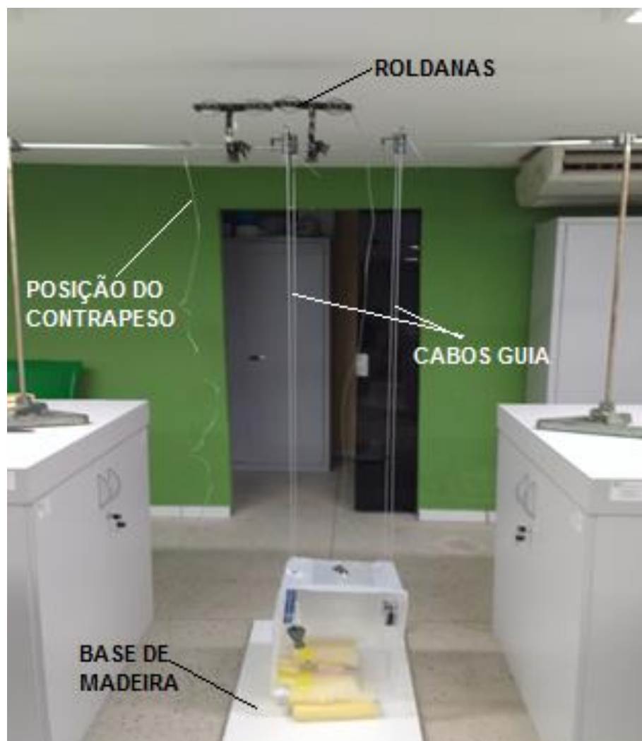
Figura 3 Estrutura montada sobre as bancadas.
