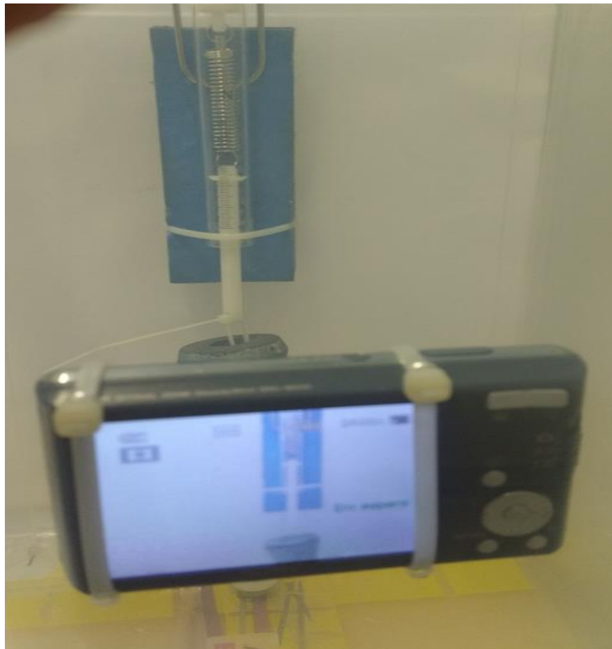
Figura 8 Enquadramento da imagem do experimento (dinamômetro) na câmera digital.
