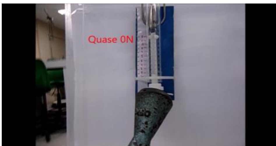
Figura 14. Vídeo 4 – Dinamômetro em queda sem contrapeso.
