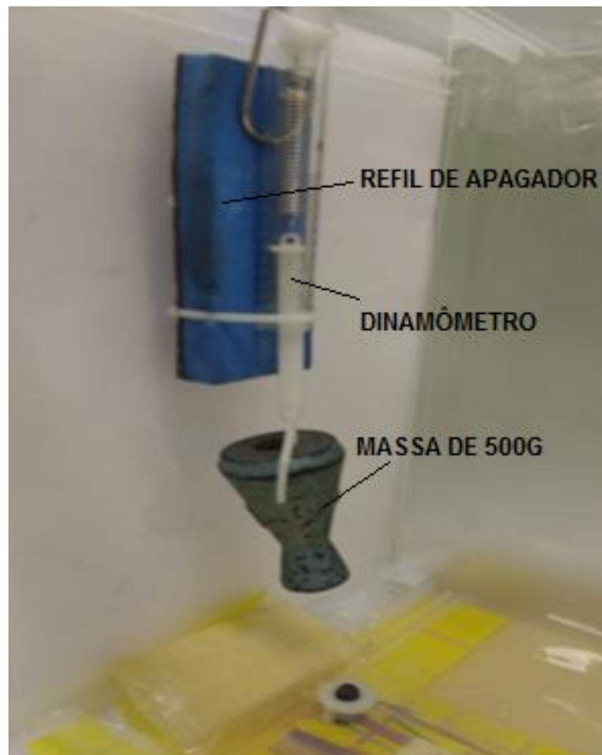
Figura 7 Detalhes da fixação do dinamômetro
