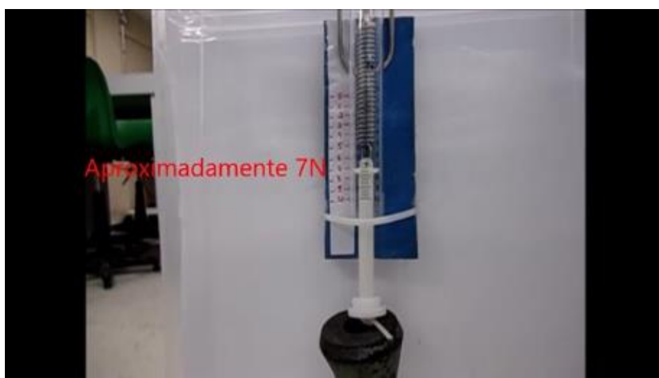
Figura 18. Vídeo 5 – Dinamômetro subindo com contrapeso de 3 kg.
