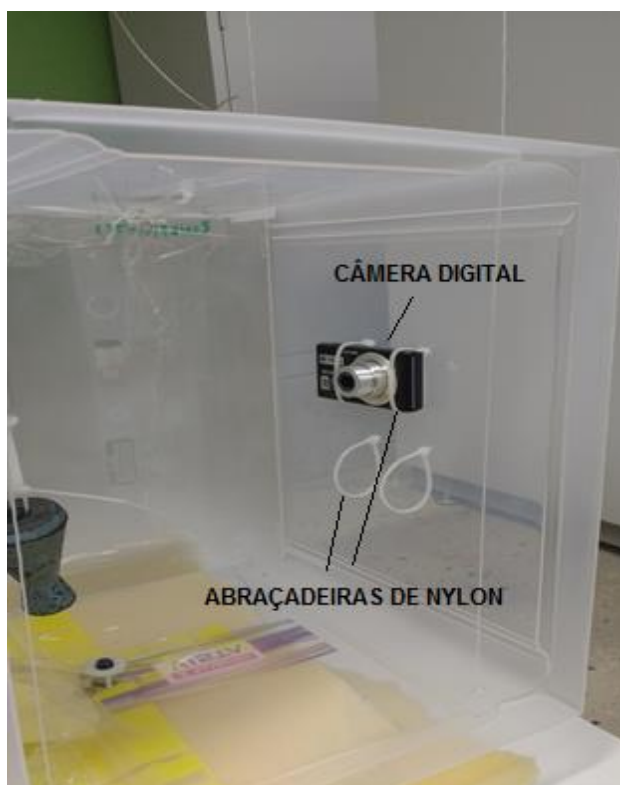
Figura 6 Detalhes da fixação da câmera digital.
