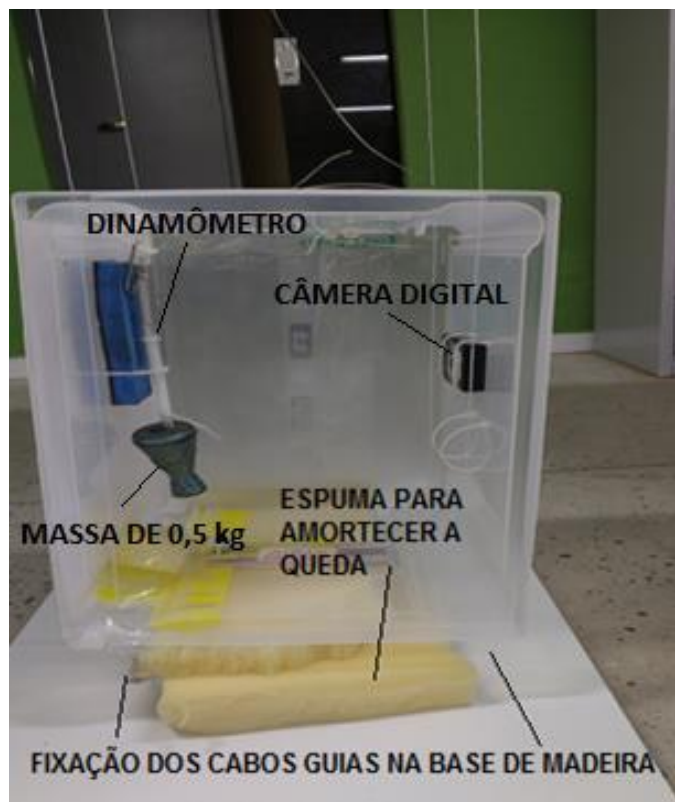
Figura 5 Vista lateral da caixa. Câmera digital e Dinamômetro com uma massa de 0,5 kg fixada.
