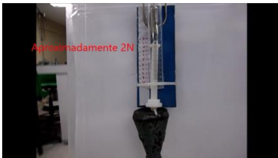
Figura 13. Vídeo 3 - Dinamômetro em queda com contrapeso de 0,2 kg.
