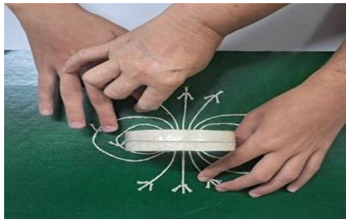
Figura 61: Análise e compreensão sobre os fenômenos acerca do campo magnético gerado por uma espira circular.
