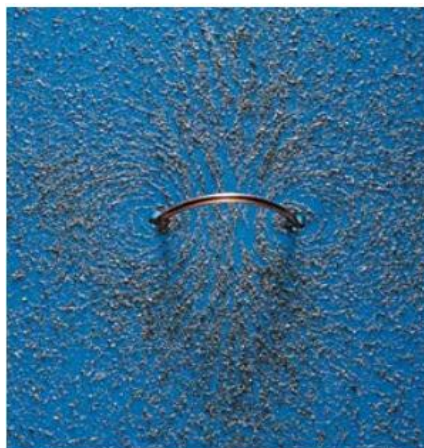
Figura 19: Configuração do campo magnético gerado por uma espira circular utilizando limalha de ferro.
