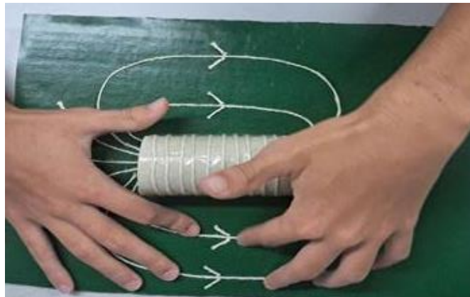
Figura 63: Análise do aparato experimental adaptado sobre o campo magnético gerado por um solenoide.
