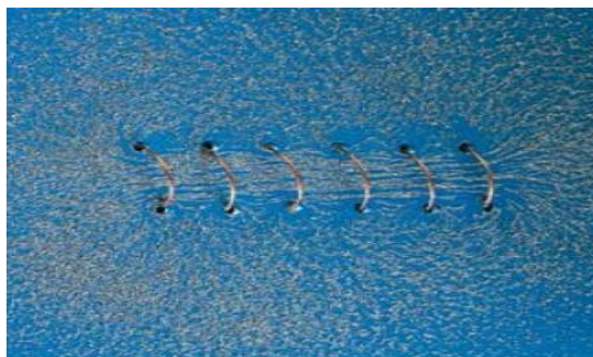
Figura 22: Configuração do campo magnético gerado por um solenoide utilizando limalha de ferro.
