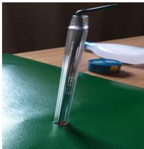
Figura 35: Fio condutor retilíneo sobreposto ao suporte pronto.
