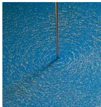
Figura 17: Configuração do campo magnético gerado por um fio retilíneo utilizando limalha de ferro.
