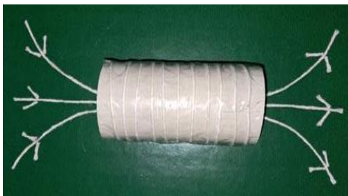
Figura 49: Construção das linhas de campo magnético num solenoide.
