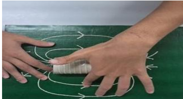
Figura 62: Compreensão do aparato experimental sobre o campo magnético gerado por um solenoide.
