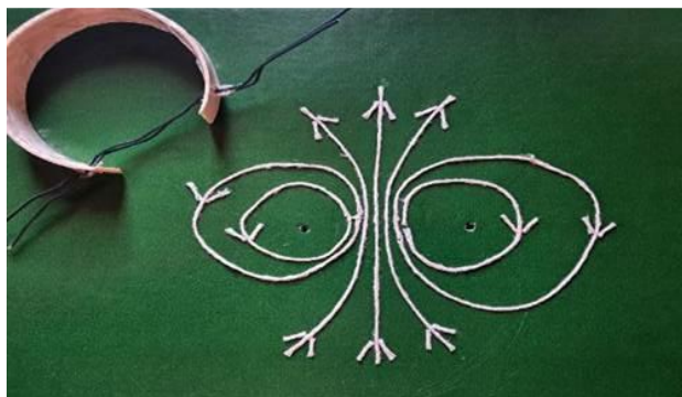
Figura 41: Arame acoplado ao cano PVC e as linhas de campo magnético alocadas no entorno dos furos para o encaixe deste cano na placa de papelão.
