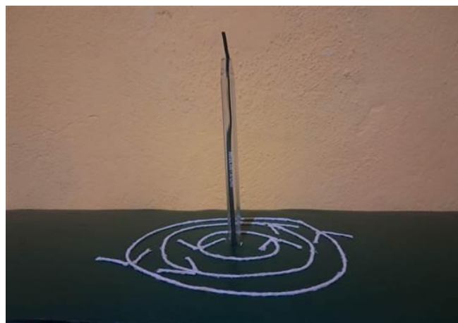
Figura 36: Material tátil para o estudo do magnetismo no fio condutor retilíneo.
