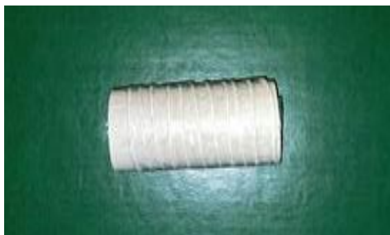
Figura 48: Estrutura central do solenoide
