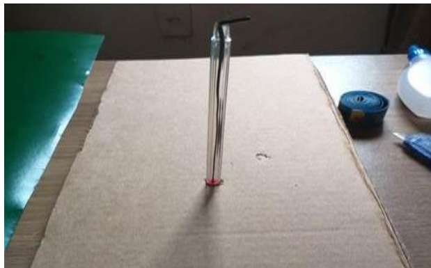
Figura 34: Fio condutor retilíneo sendo alocado no papelão para teste de encaixe.
