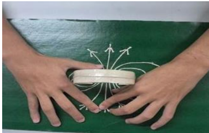
Figura 60: Exploração por parte do discente relacionada ao aparato sobre o campo magnético gerado por uma espira circular.
