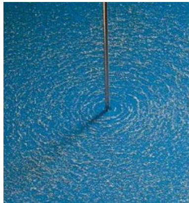
Figura 16: Configuração do campo magnético gerado por um fio retilíneo utilizando limalha de ferro.
