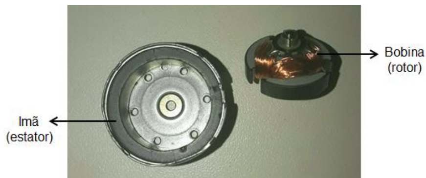
Figura 8: Motor elétrico de DVD e suas partes componentes vistos por dentro
