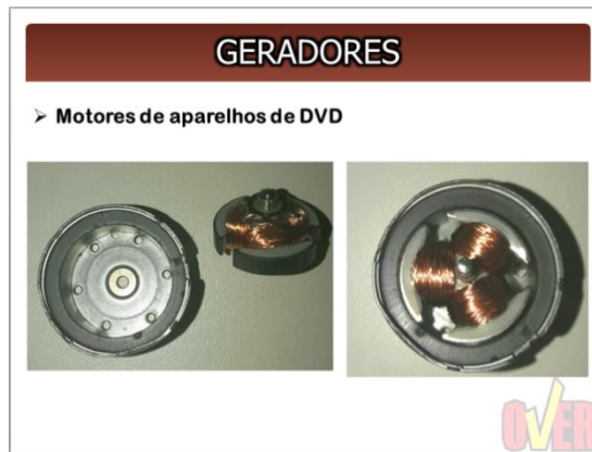
Figura 22: Slide mostrando os componentes internos de um motor de DVD
