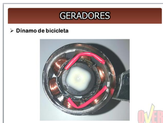
Figura 21: Slide mostrando os componentes internos de um dínamo
