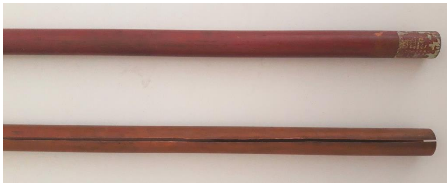
Figura 1 – Tubos de cobre (na parte superior tubo sem corte e na parte inferior tubo com corte)
