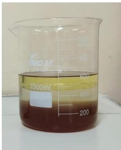
Figura 2– Demonstração experimental da densidade em diferentes líquidos
