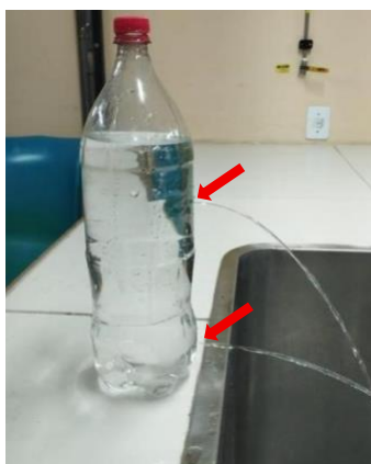
Figura 11 - Experimento da pressão hidrostática e atmosférica
