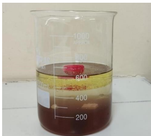
Figura 3 - Experimento De densidade com adição de objetos em líquidos imiscíveis
