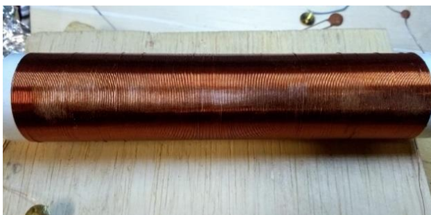
Figura 38 - Área lixada na bobina.
