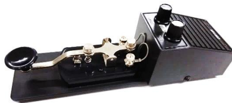
Figura 8 - Modelo de manipulador do código Morse.
