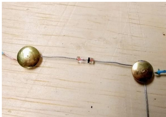
Figura 41 - Soldagem do diodo de germânio.
