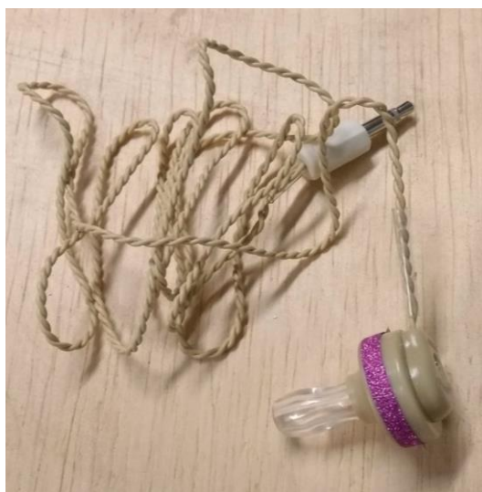
Figura 46 - Fone de cristal utilizado.
