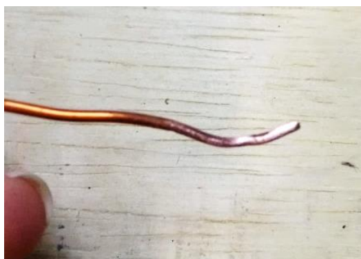
Figura 44 - Extremidade lixada do cursor.
