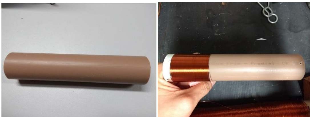
Figura 36 - Momento da confecção da bobina.
