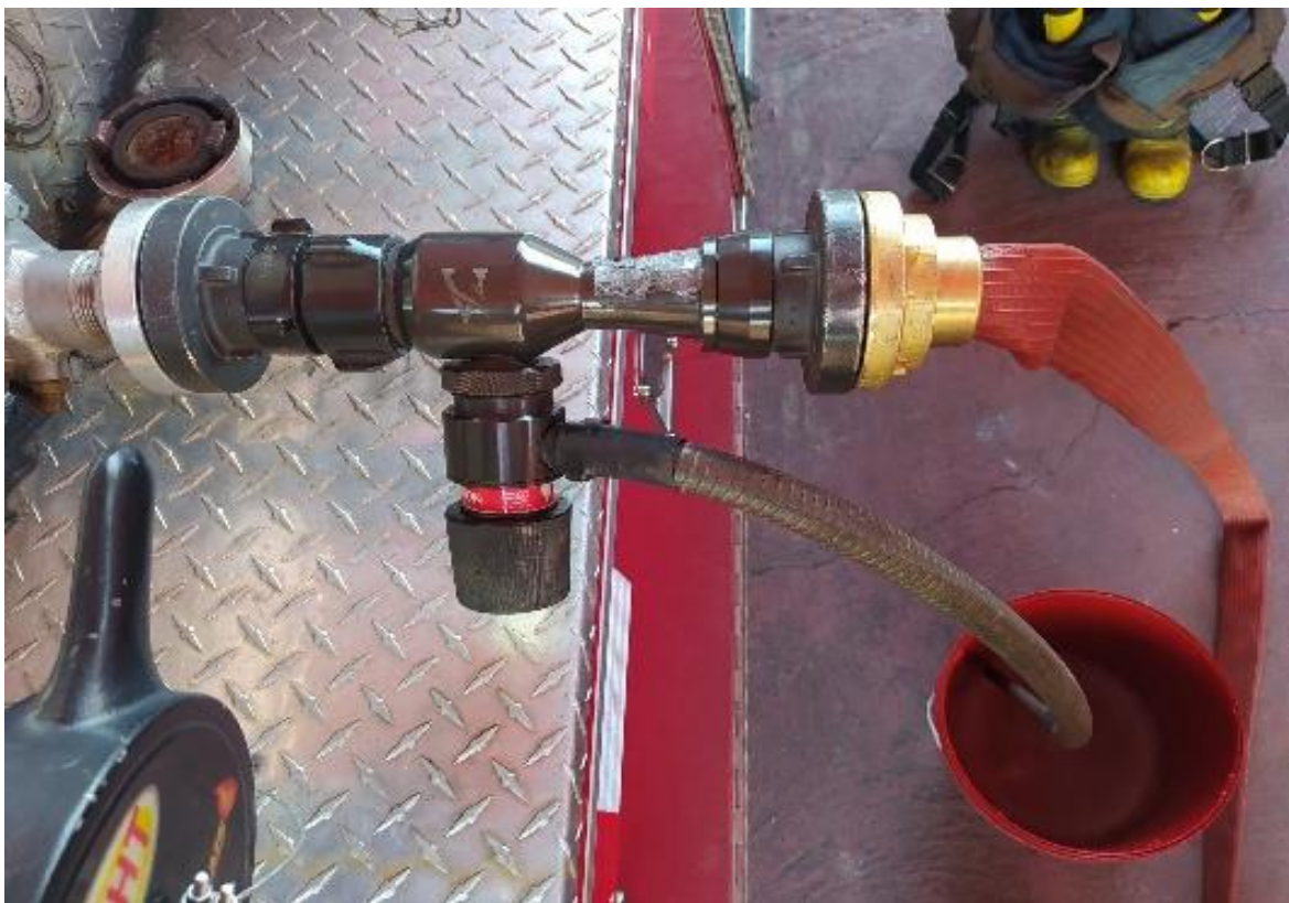
Figura: 101 - Proporcionador de espuma, montado direto na expedição do caminhão de incêndio pronto para fazer sucção do LGE. Fonte: Elaborada pelo autor.
