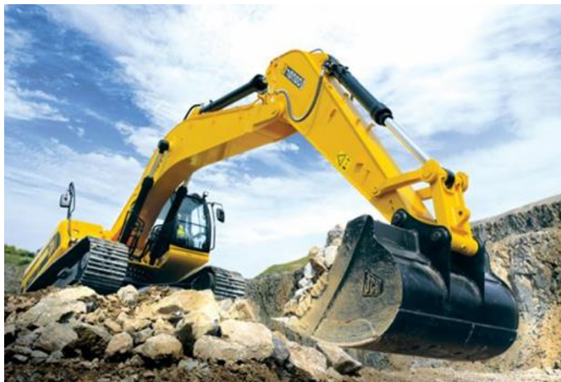
Figura: 26 – Escavadeira hidráulica
