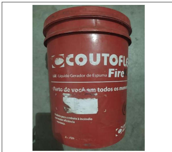
Figura 29: Líquido gerador de espuma (LGE 6%)
