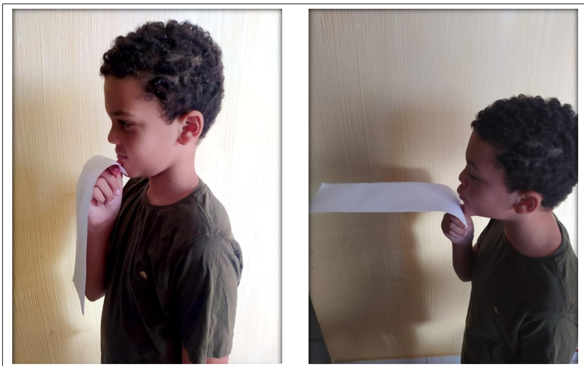
Figura 11: Tira de papel se elevando ao ser soprada por cima, um exemplo da aplicação da equação de Bernoulli”
