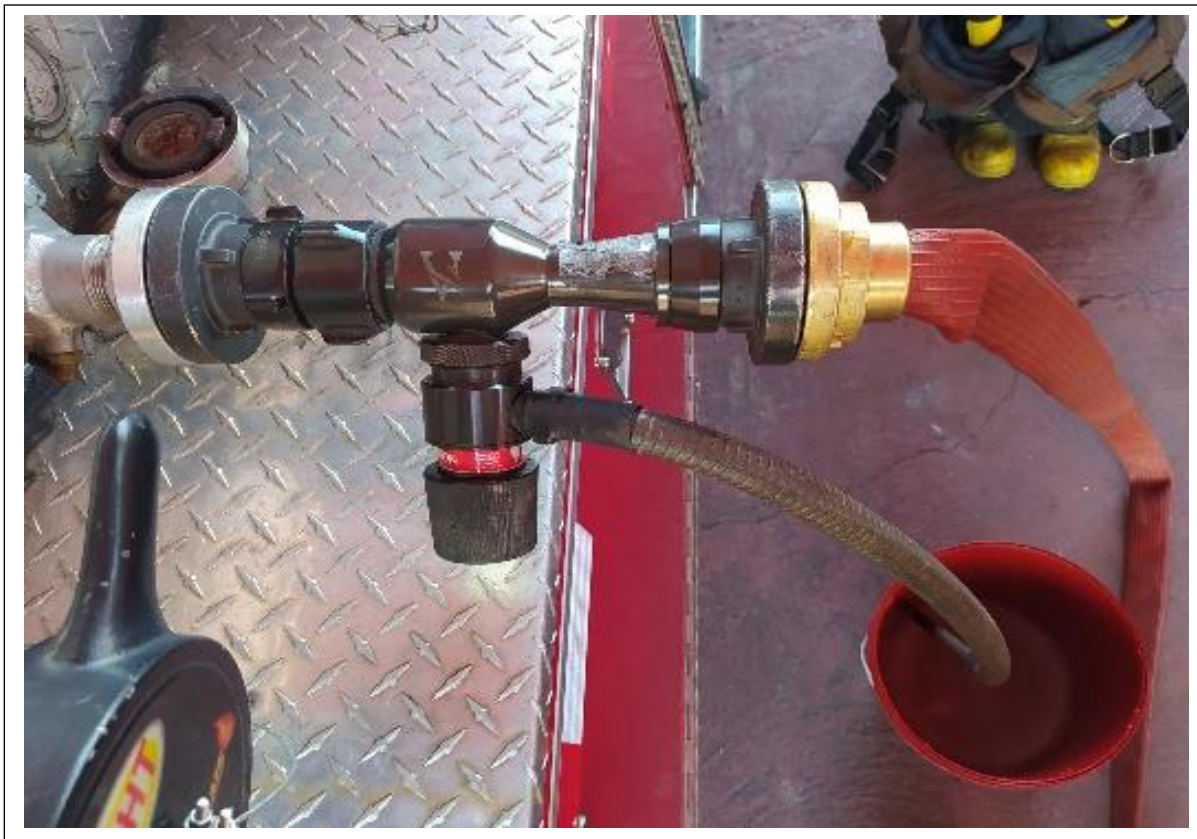
Figura 30: Proporcionador de espuma, montado direto na expedição do caminhão de incêndio pronto para fazer sucção do LGE.
