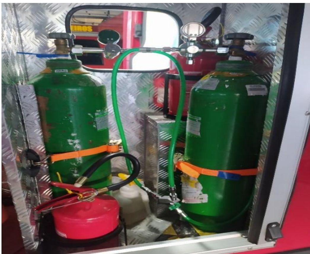
Figura: 78 - Cilindros de Oxigênio ( O_2 ), conectados a uma mangueira de saída. Fonte: Elaborada pelo autor.
