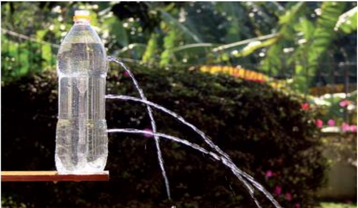
Figura: 64 - Água escoando através de três orifícios feitos em uma garrafa PET.
