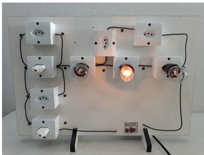
Figura 6: Painel elétrico com a montagem do circuito em série.
