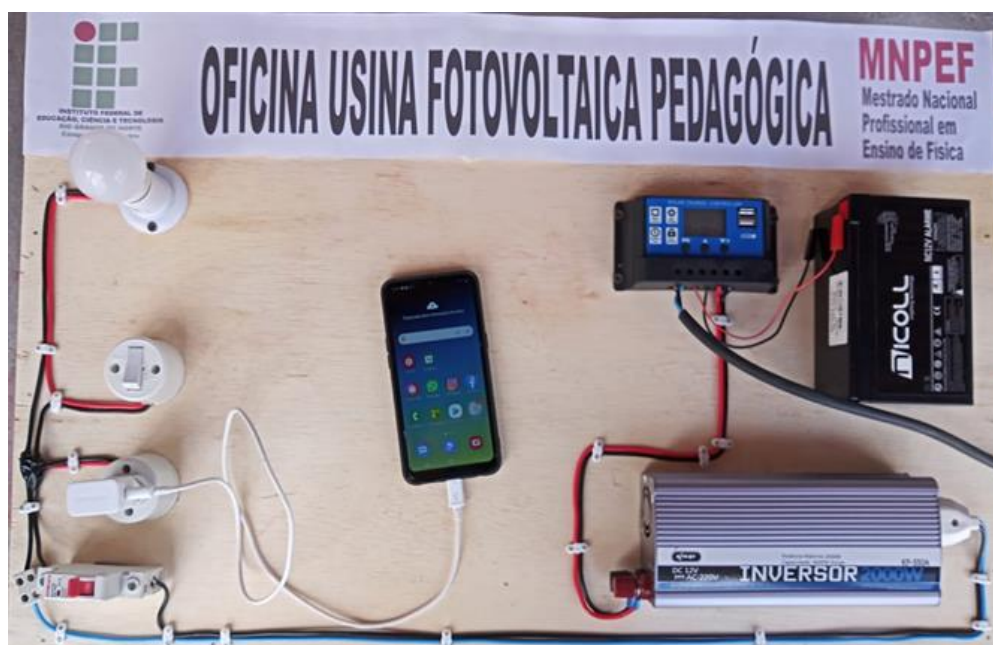
Usina fotovoltaica pedagógica com o carregamento de um celular.
