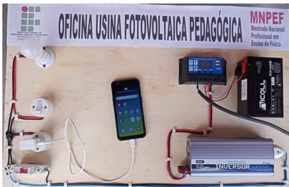
Figura 4.18 – Usina fotovoltaica pedagógica com o carregamento de um celular.
