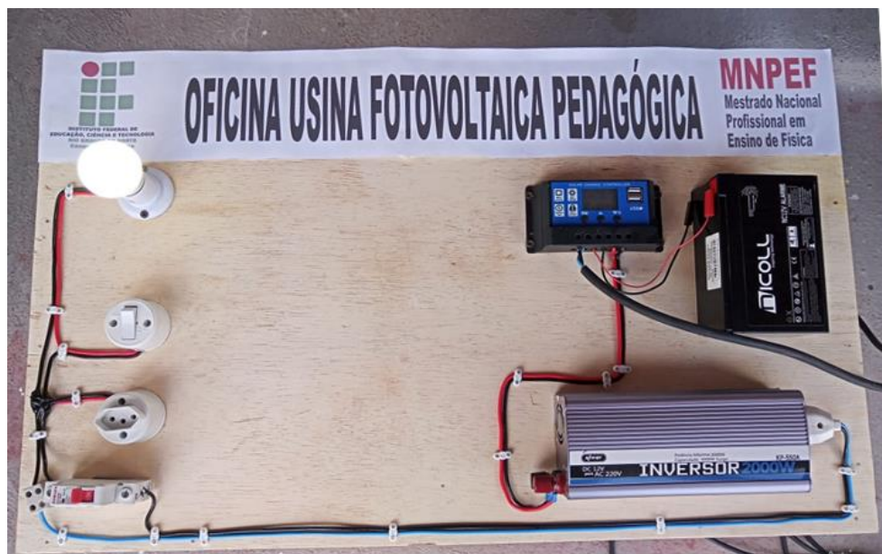
Figura 4.17 – Usina fotovoltaica pedagógica com a lâmpada de led acesa.
