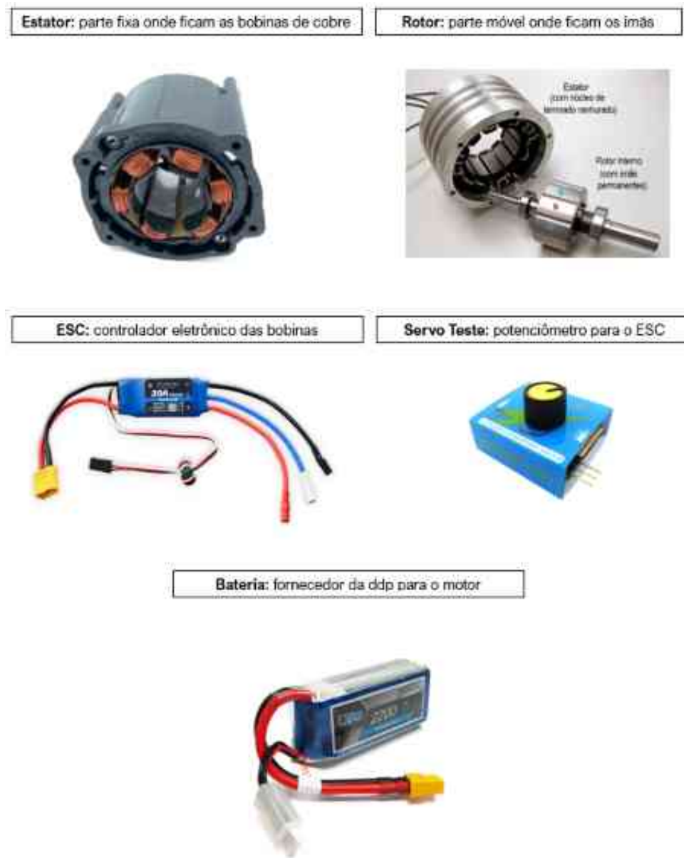
Figura 6 – Ficha ilustrativa para identificação dos componentes do motor brushless
