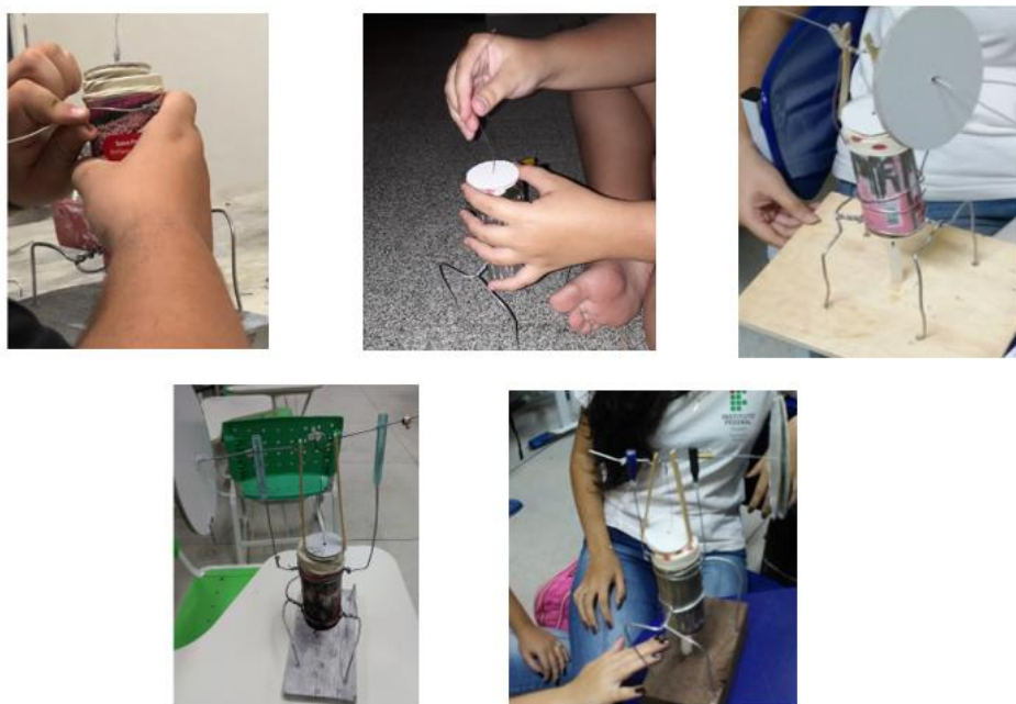
FIGURA 19: Montagem dos motores
