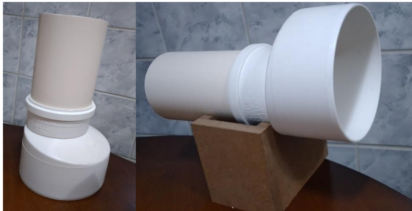
Figura 2 – Cano e redução PVC no suporte
