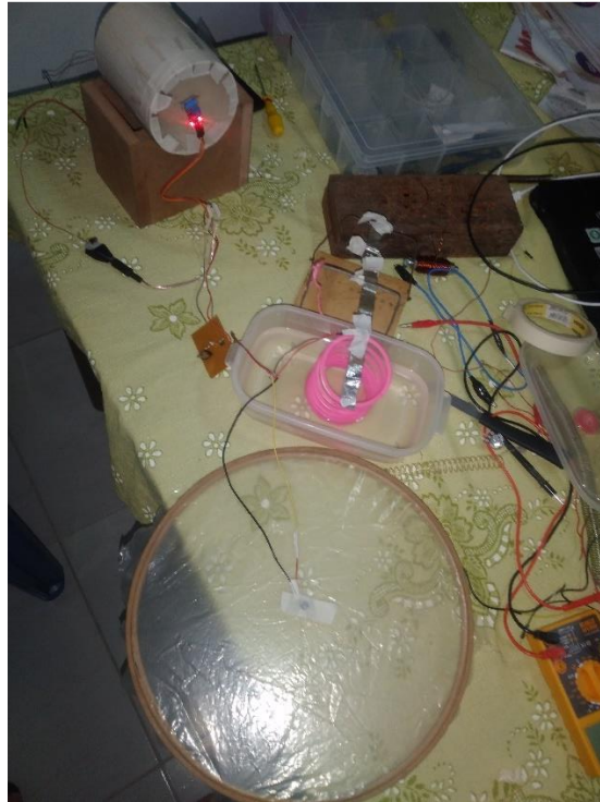
Figura 21 – Dissipação da vibração em uma superfície plástica
