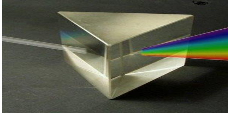
Figura 3: Imagem da decomposição da luz branca em um prisma Fonte: http://ascoresdaimaginacao.wordpress.com/2010/03/21/a-cor-e-a-luz/
