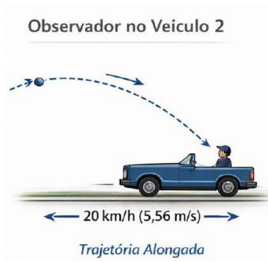
Figura 14 - Trajetória parabólica da bola lançada verticalmente a partir de um veículo em movimento retilíneo e uniforme, conforme observada no referencial do veículo 2
