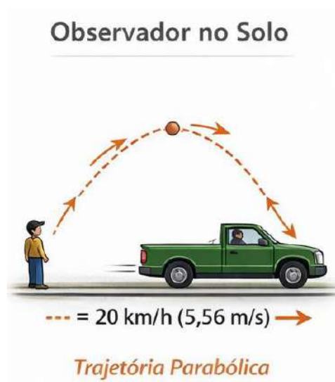
Figura 12 - Trajetória parabólica da bola lançada verticalmente a partir de um veículo em movimento retilíneo e uniforme, conforme observada no referencial do solo
