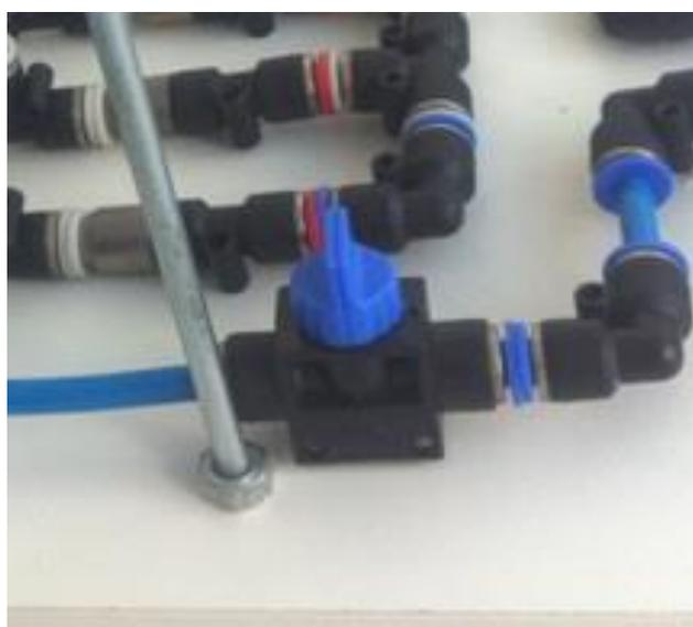
Figura 54: Válvula de bloqueio (utilizado para abrir e fechar o sistema).
