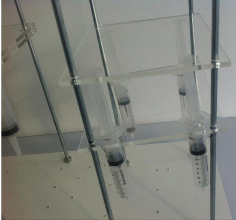
Figura 66: Placa da parte de baixo fixa e a placa de cima móvel, para que o objeto colocado nessa plataforma seja elevado.
