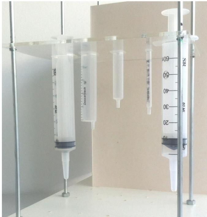
Figura 63: Seringas de 1 ml, 5 ml, 20 ml e 60 ml que compõem a plataforma de acionamento.
