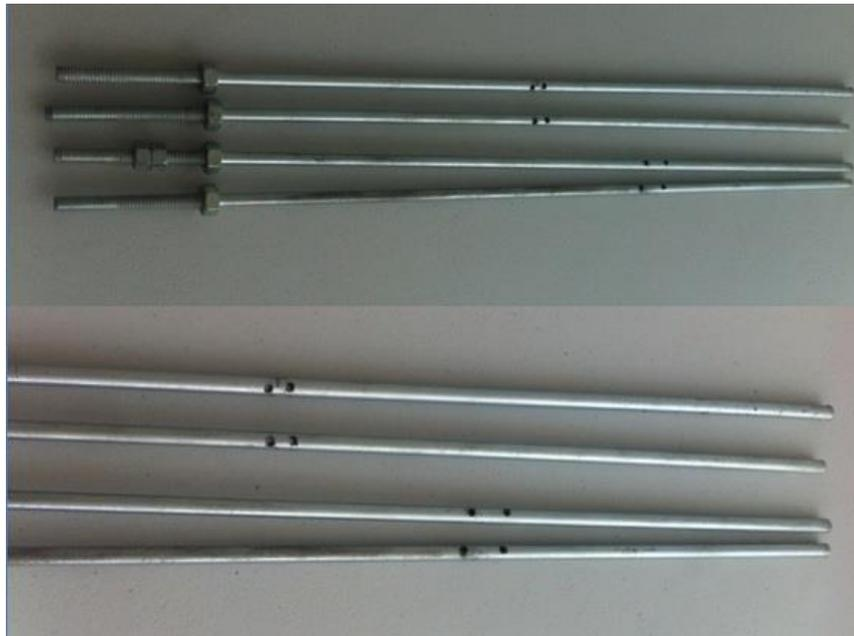
Figura 24: Hastes furadas por broca de 1 milímetro, após marcação da altura das placas.
