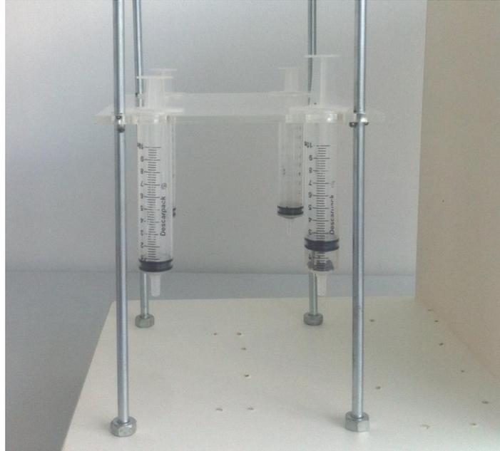
Figura 50: Vista lateral da plataforma de elevação: conjunto (haste + placas + seringas).
