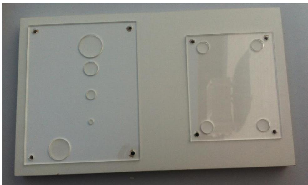
Figura 18: Placas de acrílico em cima da base para marcar onde serão os furos para as hastes de metal.
