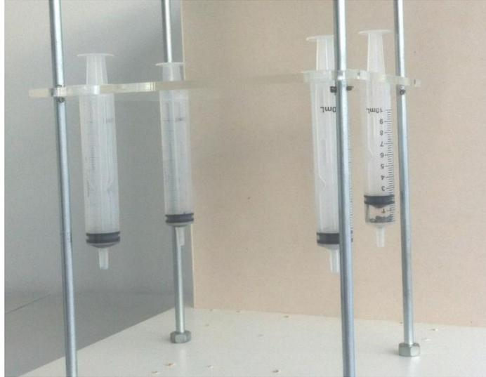
Figura 64: Seringas de 10 ml que compõem a plataforma de elevação.
