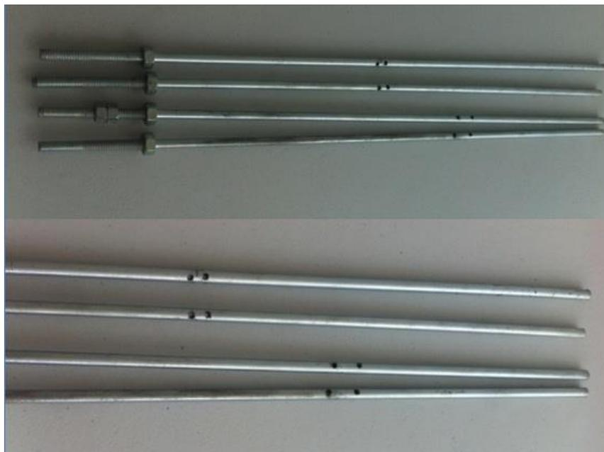
Figura 61: Hastes furadas por broca de 1 milímetro, após marcação da altura das placas.
