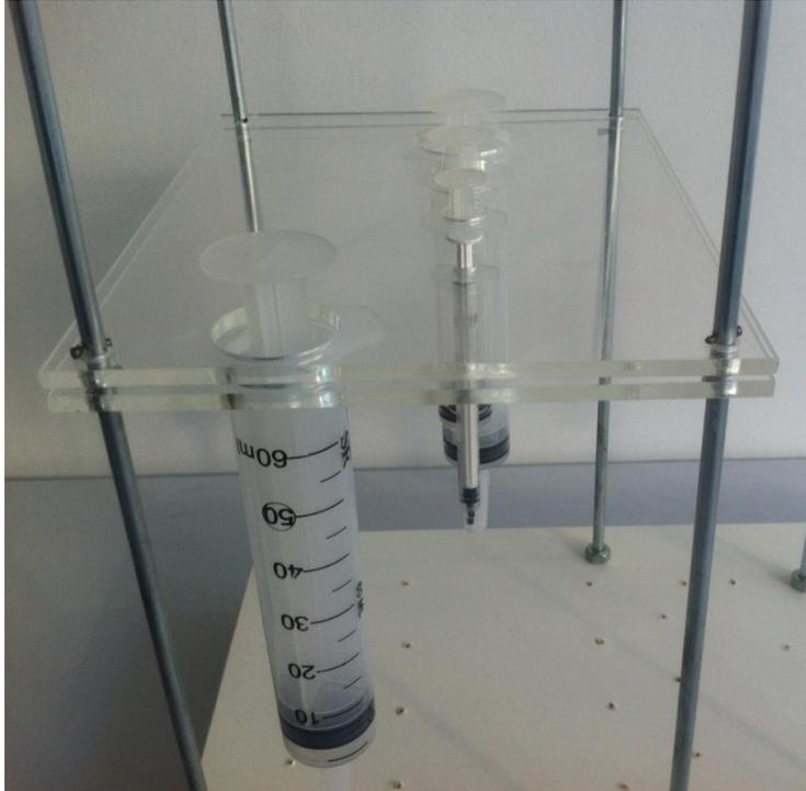
Figura 28: Placa de cima da plataforma de acionamento pressionando as seringas contra a placa de baixo, de modo que elas fiquem sem folgas.
