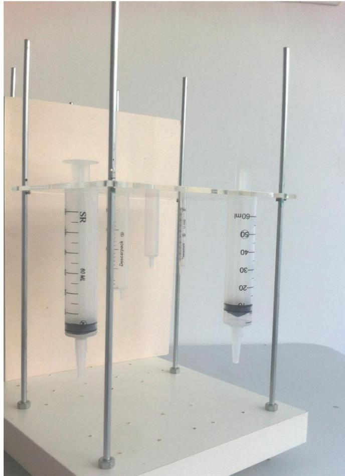
Figura 49: Vista lateral da plataforma de acionamento: conjunto (haste + placas + seringas).
