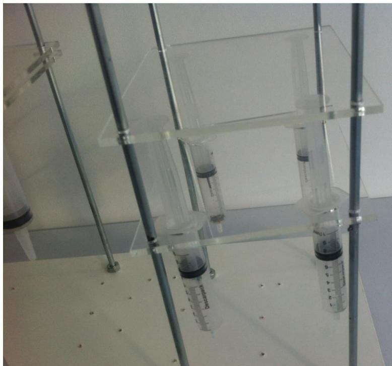
Figura 29: Placa da parte de baixo fixa e a placa de cima móvel, para que o objeto colocado nessa plataforma seja elevado.
