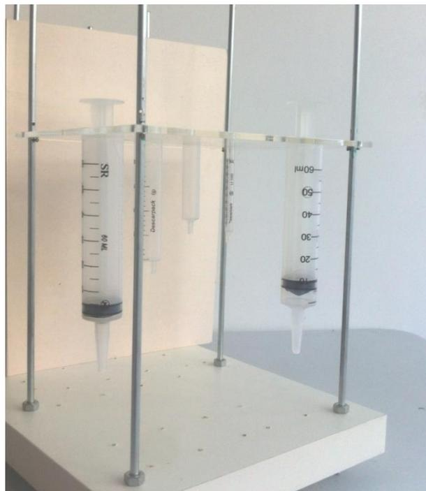
Figura 12: Vista lateral da plataforma de acionamento: conjunto (haste + placas + seringas).
