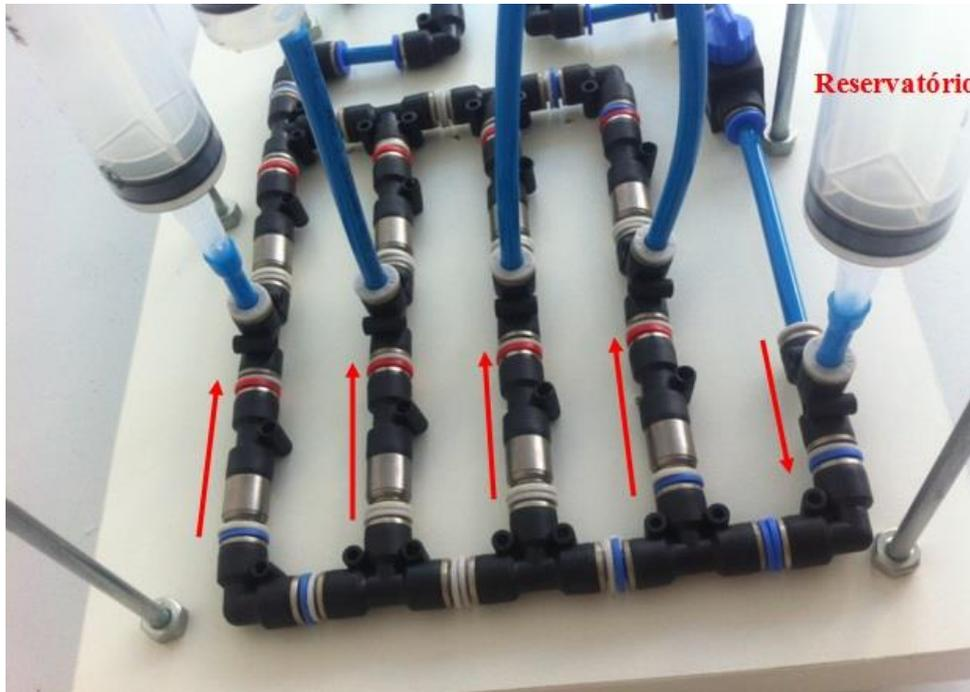
Figura 52: Vista das conexões união de retenção (entre as seringas da plataforma de acionamento e o reservatório, evitando o retorno do fluido para o reservatório).
