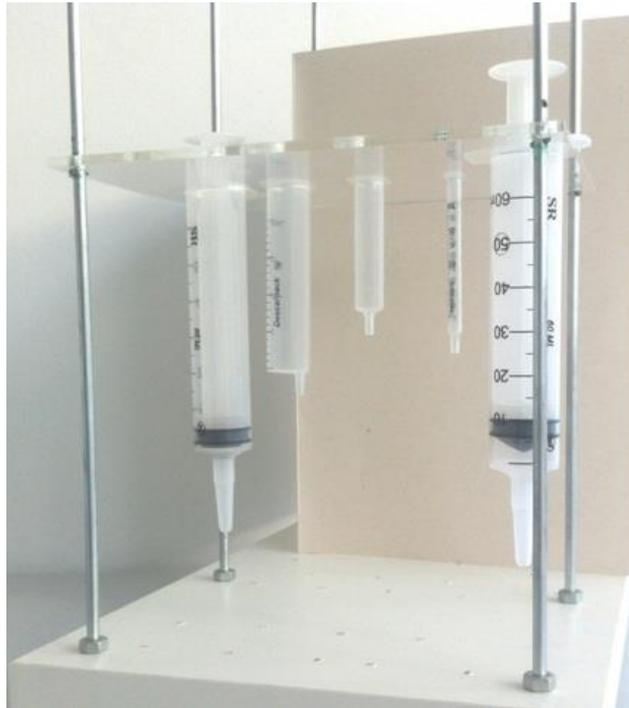
Figura 43: Vista lateral da plataforma de acionamento: haste + seringas + placas em acrílico.
