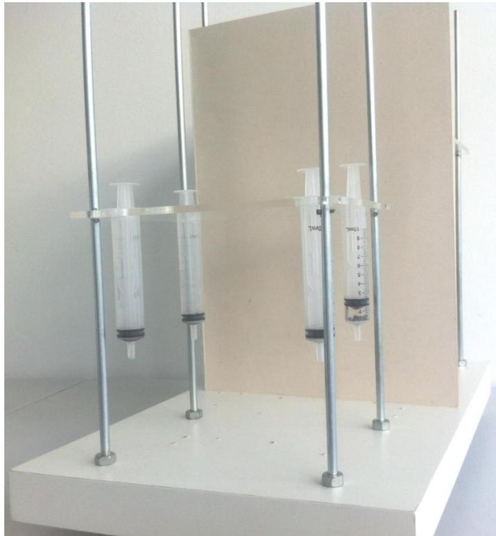
Figura 7: Vista lateral da plataforma de elevação: haste + seringas + placas em acrílico.
