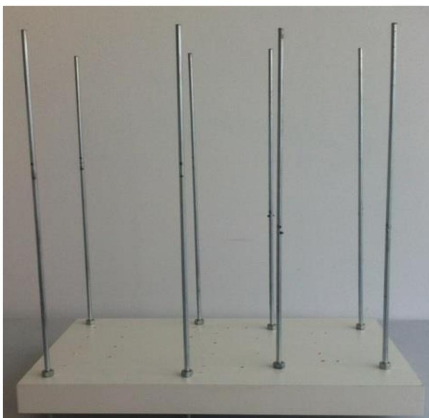
Figura 57: Hastes fixadas na base em MDF.
