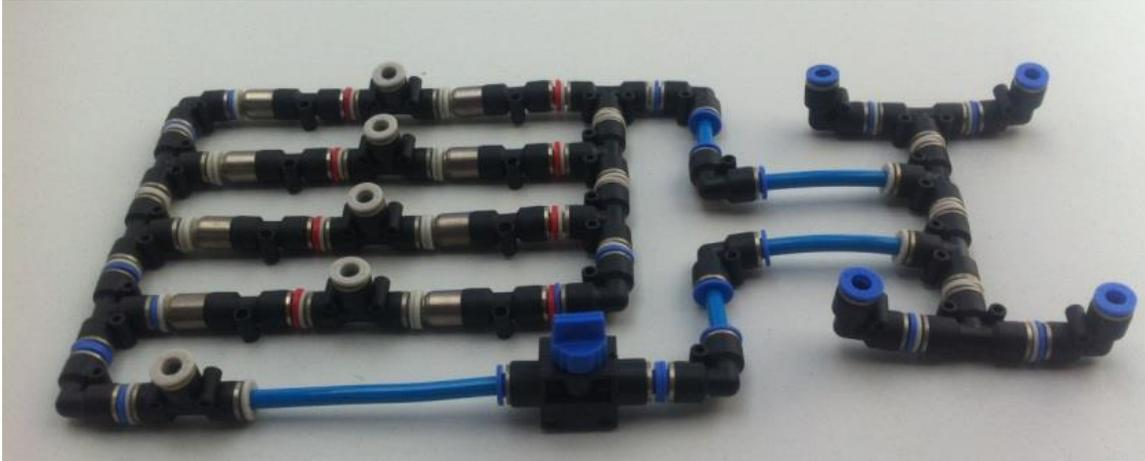
Figura 45: Vista superior do sistema hidráulico, composto pelas conexões e tubos PU.
