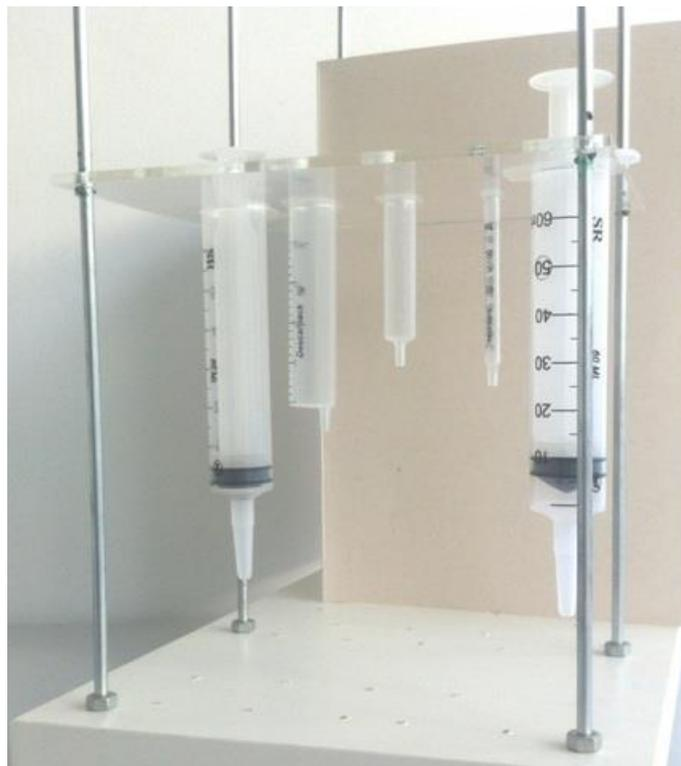
Figura 6: Vista lateral da plataforma de acionamento: haste + seringas + placas em acrílico.
