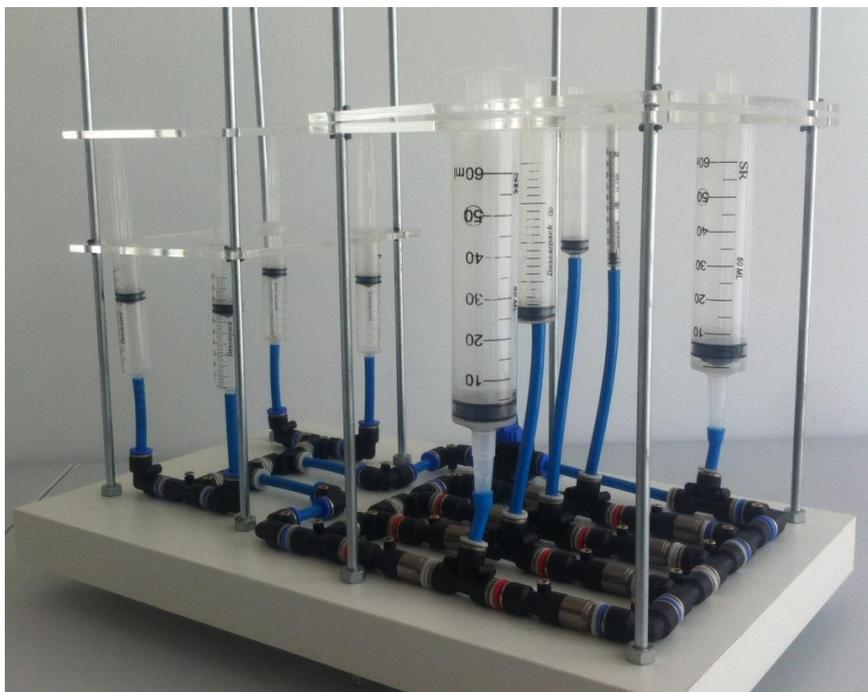
Figura 33: Todas as partes do elevador conectadas por tubos PU.
