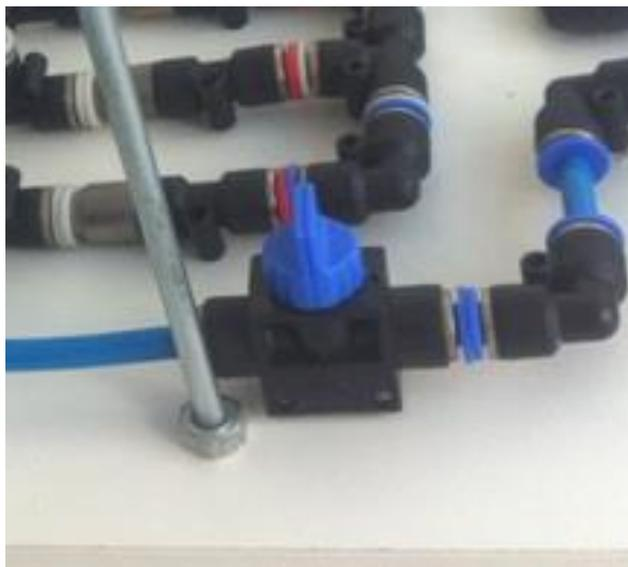
Figura 17: Válvula de bloqueio (utilizado para abrir e fechar o sistema).
