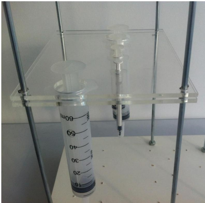
Figura 65: Placa de cima da plataforma de acionamento pressionando as seringas contra a placa de baixo, de modo que elas fiquem sem folgas.
