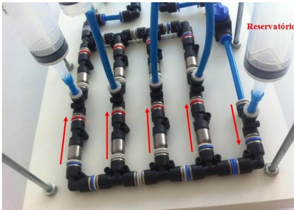
Figura 15: Vista das conexões união de retenção (entre as seringas da plataforma de acionamento e o reservatório, evitando o retorno do fluido para o reservatório).
