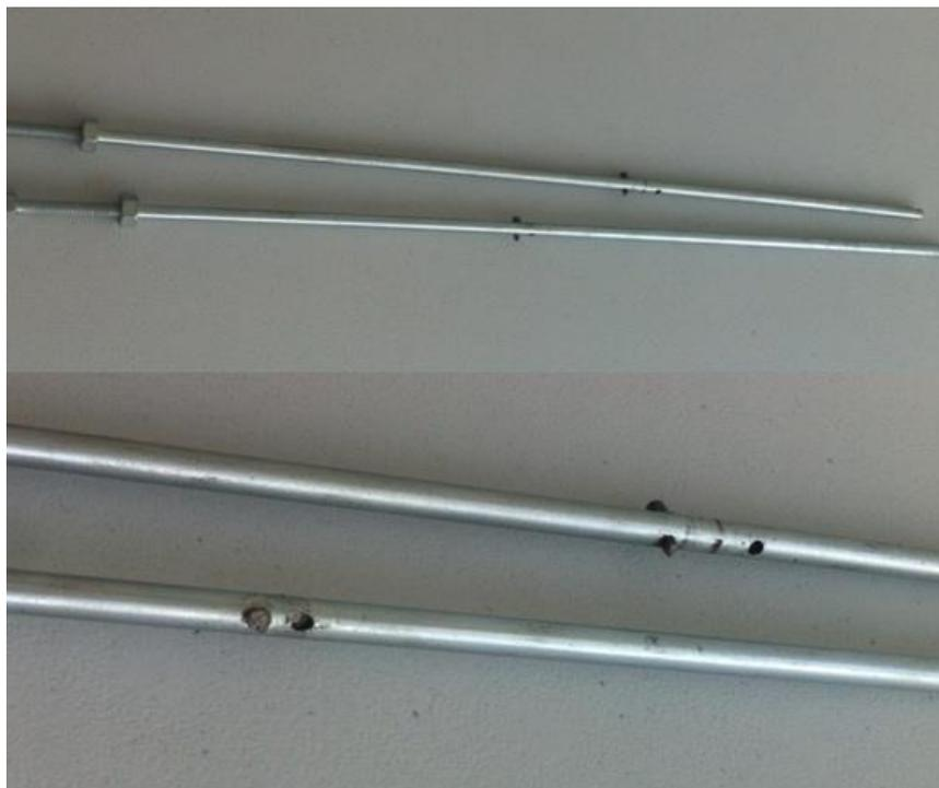
Figura 25: Pedacos de pregos de mesma espessura dos furos que servirá para sustentação das placas de acrílico.
