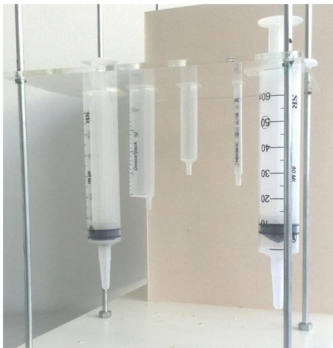
Figura 26: Seringas de 1 ml, 5 ml, 20 ml e 60 ml que compõem a plataforma de acionamento.
