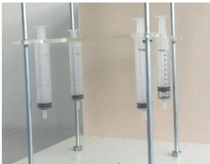
Figura 27: Seringas de 10 ml que compõem a plataforma de elevação.
