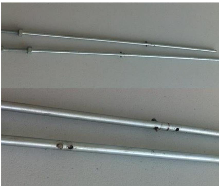
Figura 62: Pedacos de pregos de mesma espessura dos furos que servirá para sustentação das placas de acrílico.
