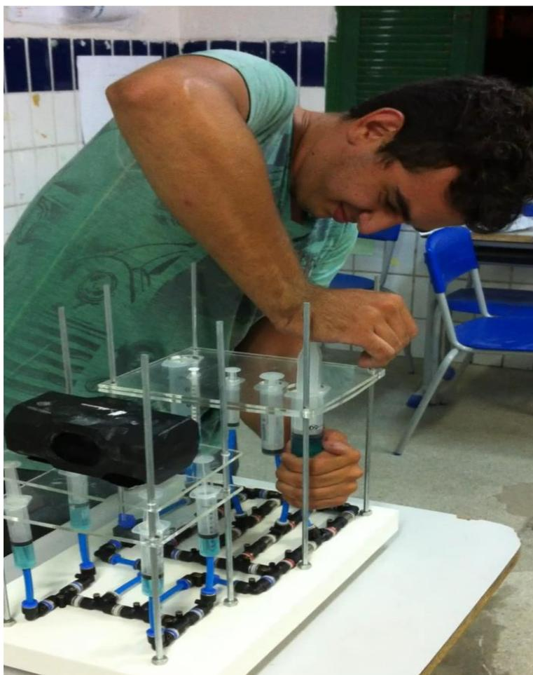
Figura 39: Aluno utilizando o aparato experimental para comprovar o princípio de Pascal.
