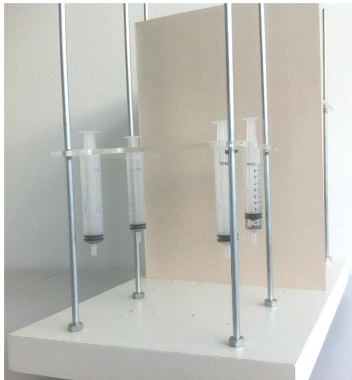
Figura 44: Vista lateral da plataforma de elevação: haste + seringas + placas em acrílico.
