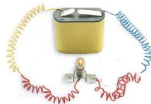
Figura 25. Circuito elétrico simples
