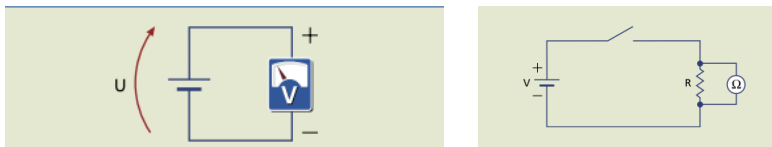
Figura 1.7 Representação de um voltímetro medindo a diferença de potencial entre os terminais do gerador.
