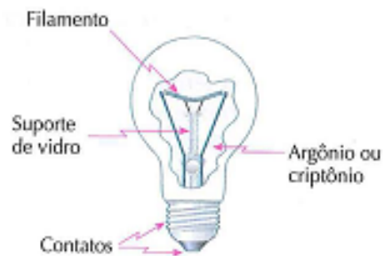
Figura 47. Detalhes de uma lâmpada de filamento
