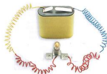
Figura 9. Circuito elétrico simples
