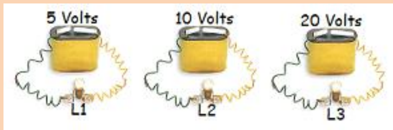
Figura 10. Circuitos elétricos simples
