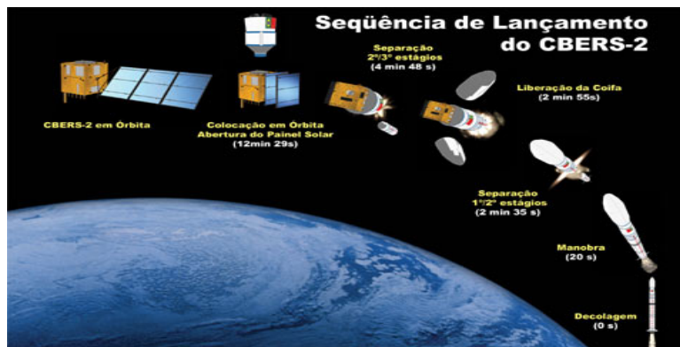
Figura 2: Sequência de lançamento de satélite em órbita
