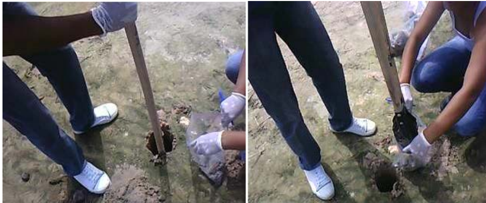
Figura 2: Retirada do solo com o uso do trado.
