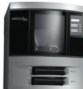
**Figura 6 - Máquina de Prototipagem de Placas LPQF (esquerda) e Impressora 3D Dimension Elite (direita).**
