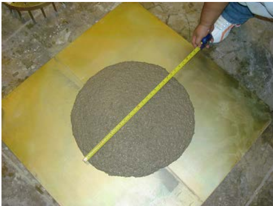
Figura 1: Ensaio slump-flow test do traço CAA-04 com 20% de substituição do cimento por metacaulim.
