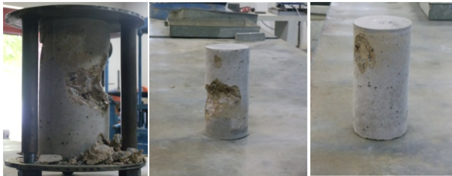
Figura 5: Corpos-de-prova após ensaio de altas temperaturas
