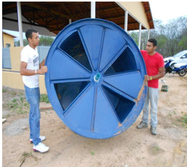
Figura V. Campânula de Polietileno adaptada para o armazenamento do biogás
