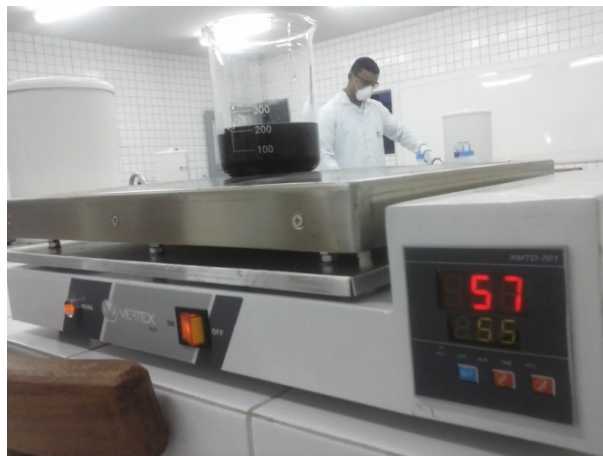
Figura 2: Solução de Metóxido de Sódio na chapa quente a 57° C
