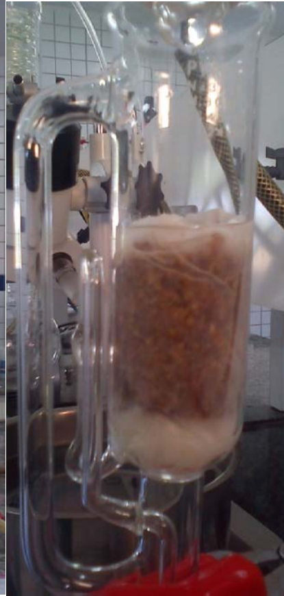
Figura 2: Cartucho com sementes trituradas do neem dentro do extrator Soxhlet
