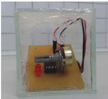
Figura 2 – Imagem do circuito utilizado no segundo protótipo.
