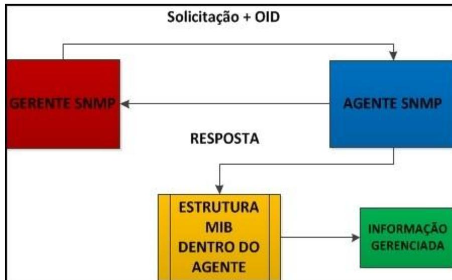
Figura 1: Comunicação utilizando SNMP. (Fonte: Própria)
