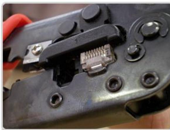
**Figura 05:** Alicates de Cripagem para conectores de rede.
