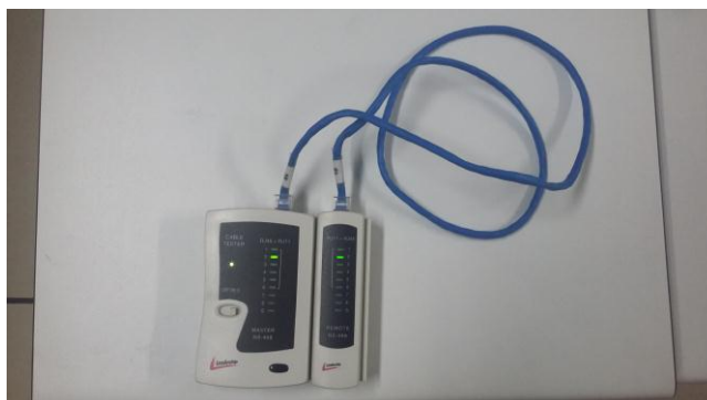
Figura 31: Teste de cabos RJ45
